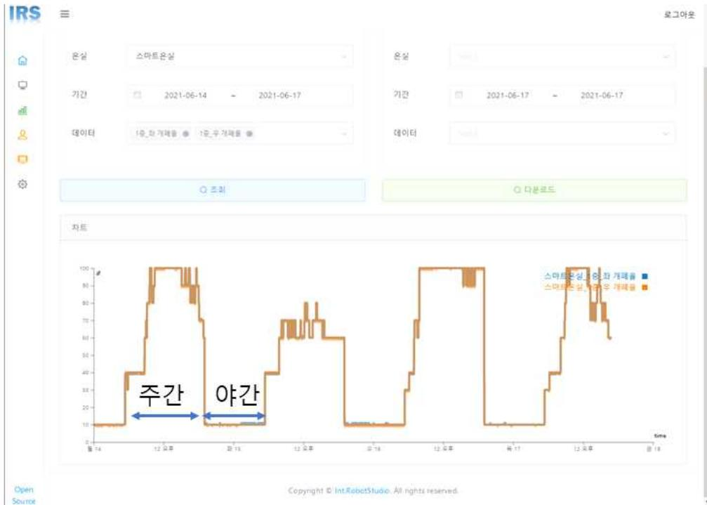
[그림 2.58] PLC 기반 통합 제어기에 의한 스마트 개폐기의 개도율 비례 제어
