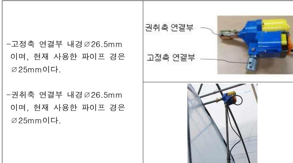
[그림 2.74] 개도를 인식 개폐기 설치 시방
