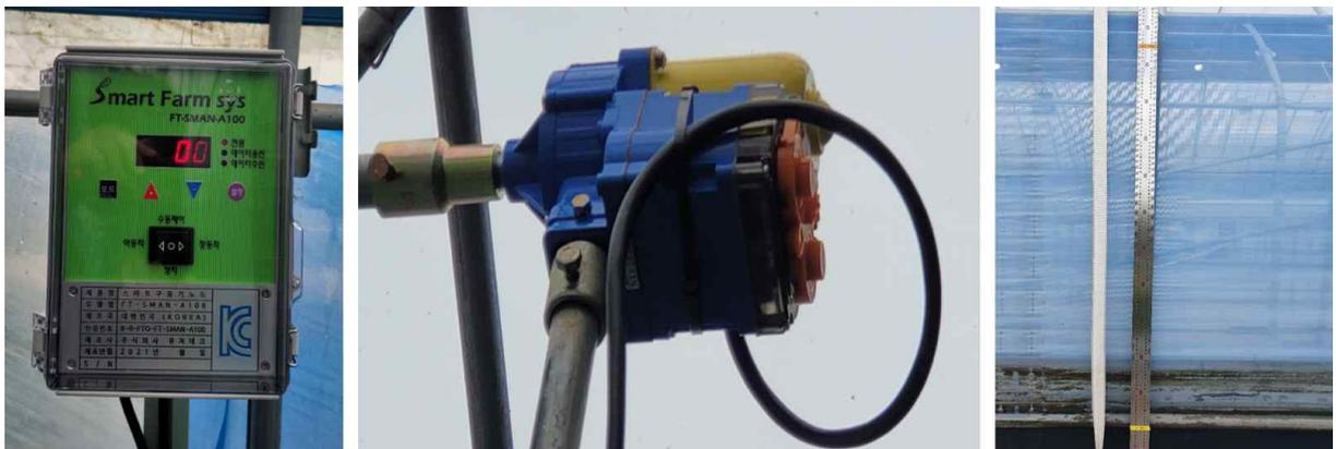
[그림 2.85] 고정철자를 이용한 개도율 오차율 측정 및 분석
