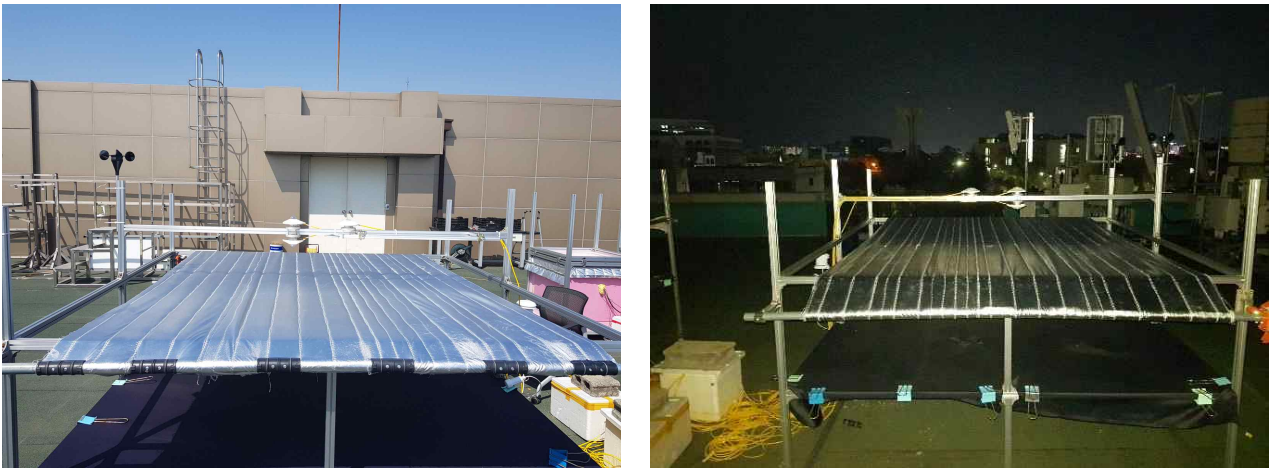
그림 2-3-6. 스크린의 열복사 실험장치 사진
