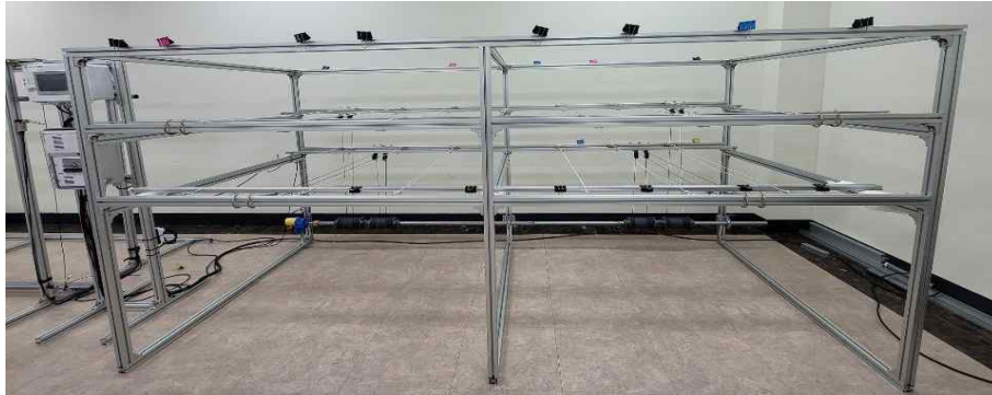
그림 2-1-1. 예인식 축진 내구성 시험장치
