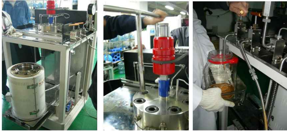
그림 30. 인삼특이사포닌 추출을 위한 고온고압 대량 추출장치
