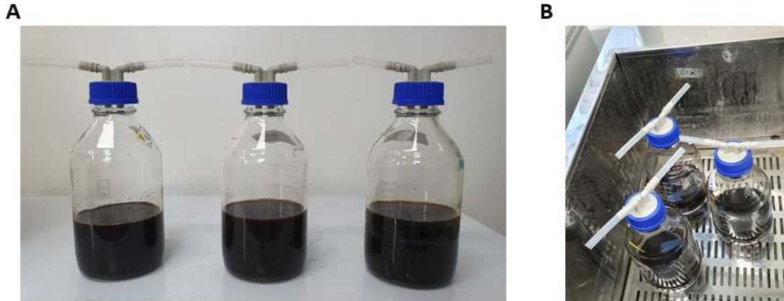
그림 4. 약취물질 저감 능력 평가 연구. 미생물제제를 이용한 돼지 분뇨에서 발생하는 약취물질 저감 효과를 측정하기 위하여 반응조를 제작하여 활용함. 상부의 호스를 통해 반응조 상층부의 공기에 포함된 약취 물질을 측정함 (A) 1리터 반응조 (B) 항온수조에서 반응 시키는 모습
