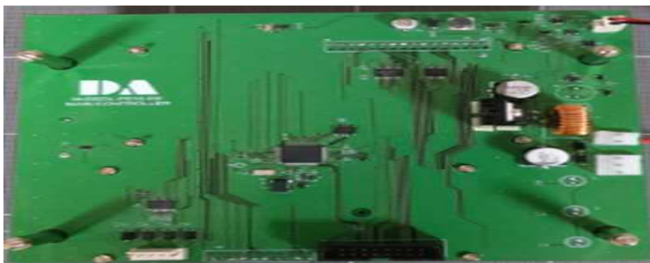
그림 92. 메인 컨트롤 파트. 신호처리를 위한 중앙 제어 프로세서로 신뢰성 확보를 위해 basic과 ladder logic을 구현 할 수 있는 장치를 선정함
