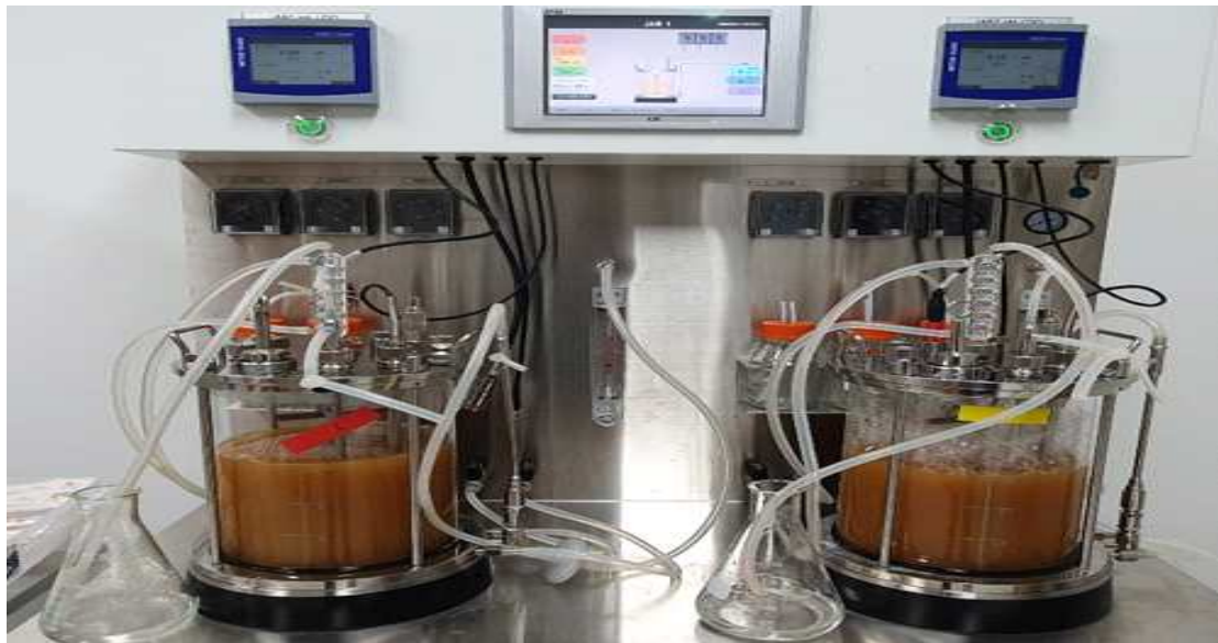
그림 46. 실험실 규모의 발효조(5L)에서 3종 미생물 복합배양 연구 수행 pilot-scale 배양 연구에 앞서 실험실 규모의 5리터 발효조에서 3종 미생물 복합 배양에 대한 최종 점검을 실시함
