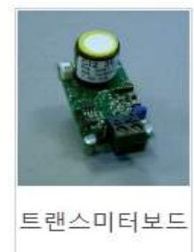
그림 85. 전기화학식 가스센서 예시. 전기화학식 가스센서는 전해질 내에서 양극과 음극의 산화 환원 반응에 의해 발생하는 전류 값의 변화를 감지하는 센서임
