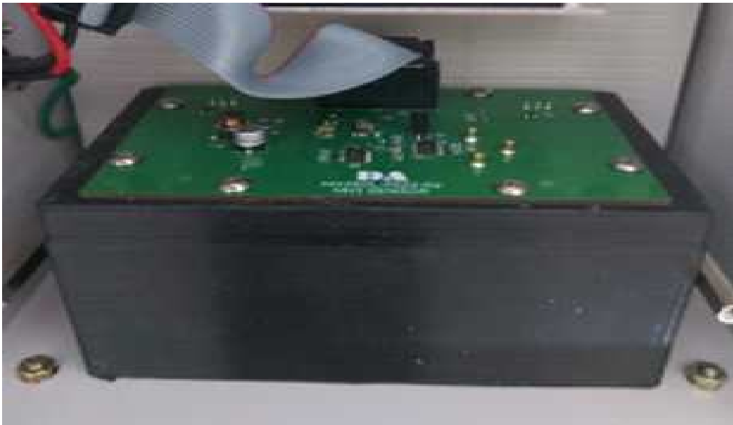
그림 94. 센서 파트. 센서 파트는 암모니아 검출 센서, 온습도 센서의 개별적용 혹은 향후 복합 적용이 가능함
