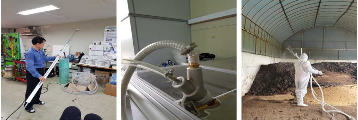
그림 82. 제작된 시험용 분사 장치의 현장 시연. 제작된 분사 노즐과 이동형 컴프레셔를 적용하여 시험용 복합미생물제제 분사 장치를 제작하였고 활용성을 평가함
