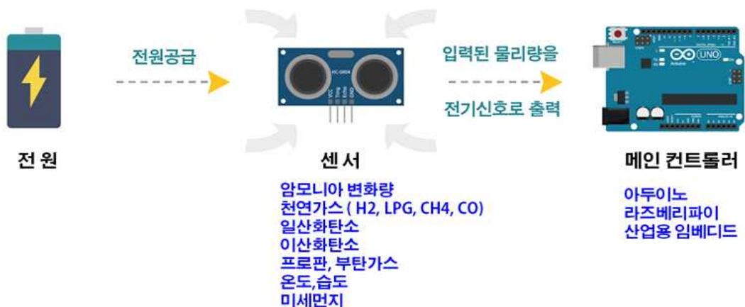
그림 80. 악취인자 측정 시스템 구동 모식도. 보급이 용이한 저가형 악취 측정기기를 제작하기 위하여 시중에서 대중적으로 사용되는 센서 모듈을 탑재한 단순한 형태의 시스템을 설계함
