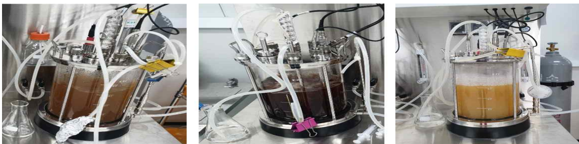
그림 29. 분말 제형화를 위한 미생물제제 배양. 5L 배양기를 이용하여 각 미생물을 30씩 배양함.
