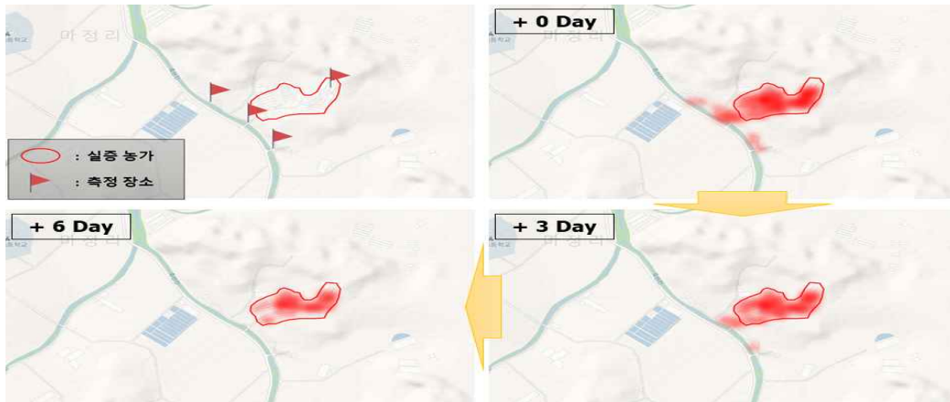
그림 64. 예비 실증 농가 주변 악취 지도 작성. 대상 농가와 진입로에서 지속적으로 악취 정도를 모니터링하여 복합미생물제제 처리에 대한 효과를 관찰함
