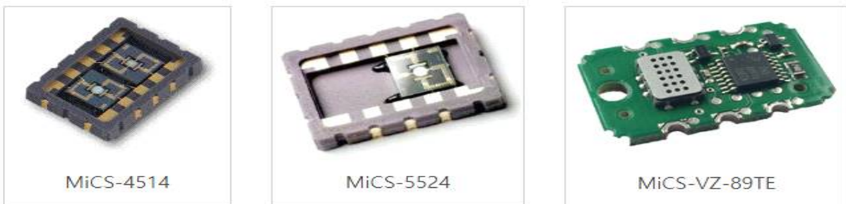
그림 87. 반도체식 가스센서 예시. 반도체식 가스센서는 세라믹 반도체 표면에 가스가 접촉했을 때의 전기전도도 변화를 이용하는 센서임
