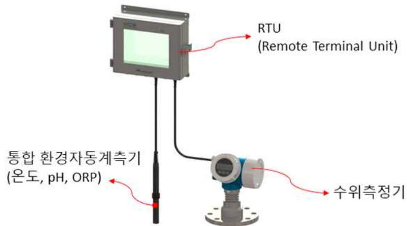
그림 12. ICT/IoT 가축분뇨 저장조 환경 및 발생량 모니터링 센서 통합시스템 개요
