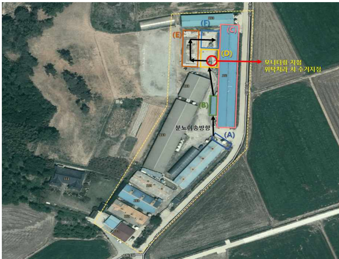
그림 3-4. A 농가의 위성사진 및 분뇨관리시설의 위치 (A, 원분뇨 저장조; B, 고액분리기; C, 퇴비화시설; D, 액상분뇨 저장조; E, 액비화시설; F, 액비저장조)
