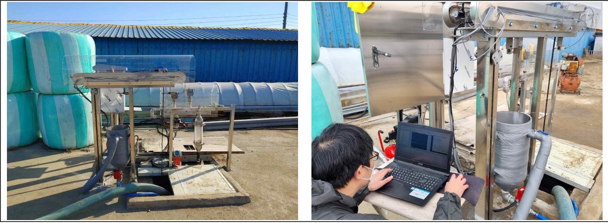
그림 5-4. 환경센서 자동세척 시스템 설치
