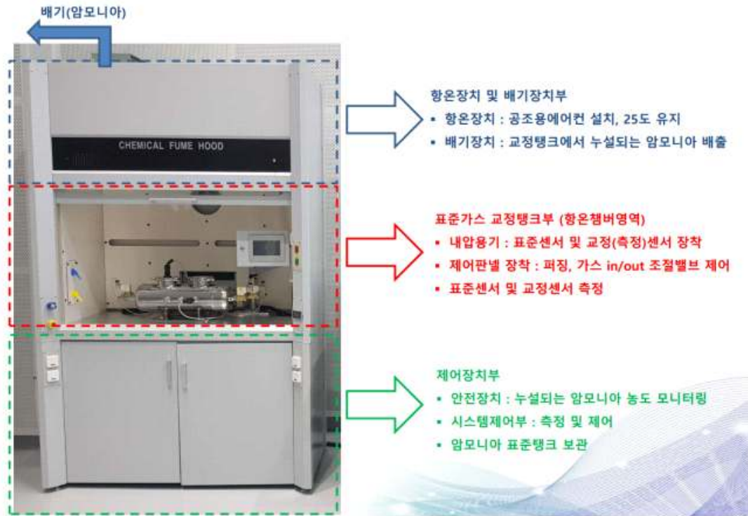
그림 17. 가축분뇨 모니터링 기자재 성능시험 시스템
