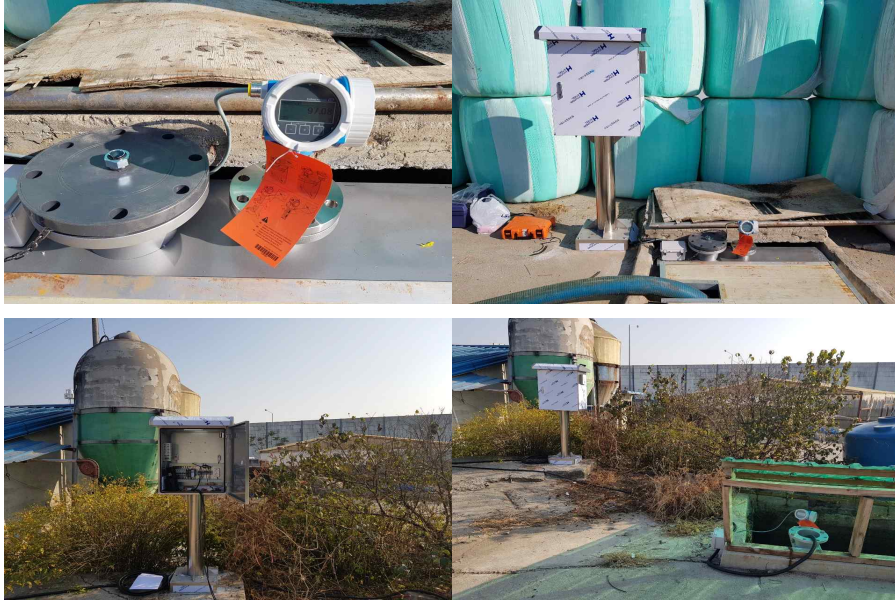
그림 1-121. 가축분뇨 발생량 측정 센서 시스템
