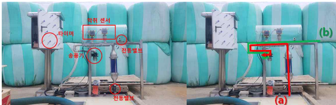
센서로 유입되는 공기의 흐름 (a) 측정-약취; (b) 세척-신선한 공기
