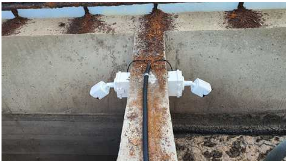
그림 124 저장조의 수위 영상 획득을 위해 설치한 카메라
