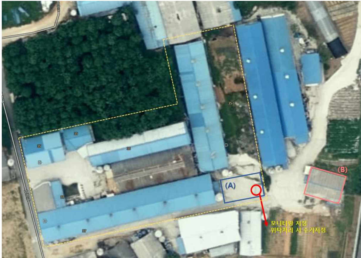
그림 3-6. B 농가의 위성사진 및 분뇨관리시설의 위치 (A, 원분뇨 저장조; B, 퇴비화시설) *액상분뇨 저장조 입구에서 수위, 분뇨 성상 변화인자, 환경 영향인자 모니터링
