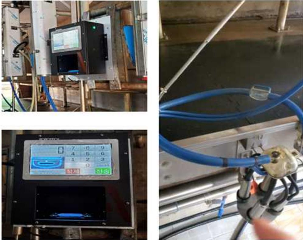
[그림2-41] A목장 유방염 모니터링 장비 설치
