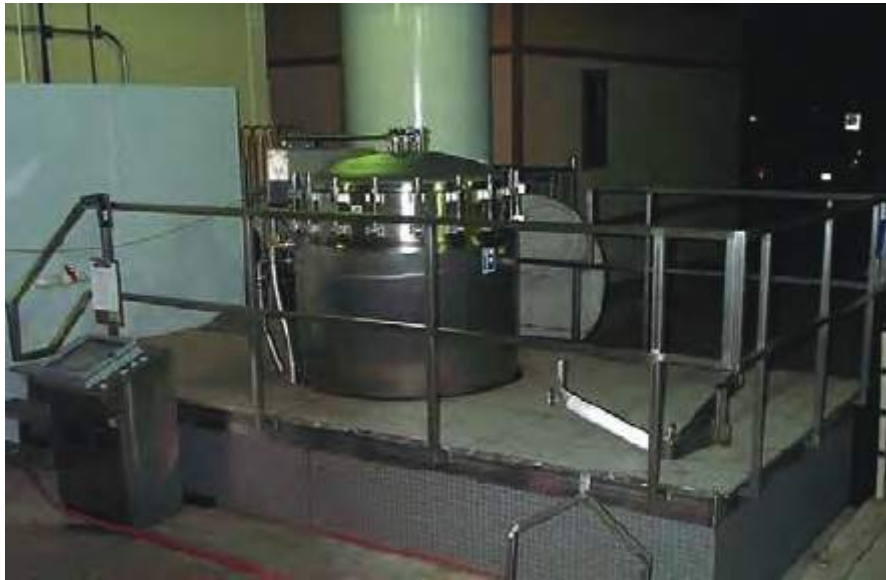
<그림 33> 약 1,000 kg 용량의 알칼리 가수분해 장치 예 (Powers, 2003)
