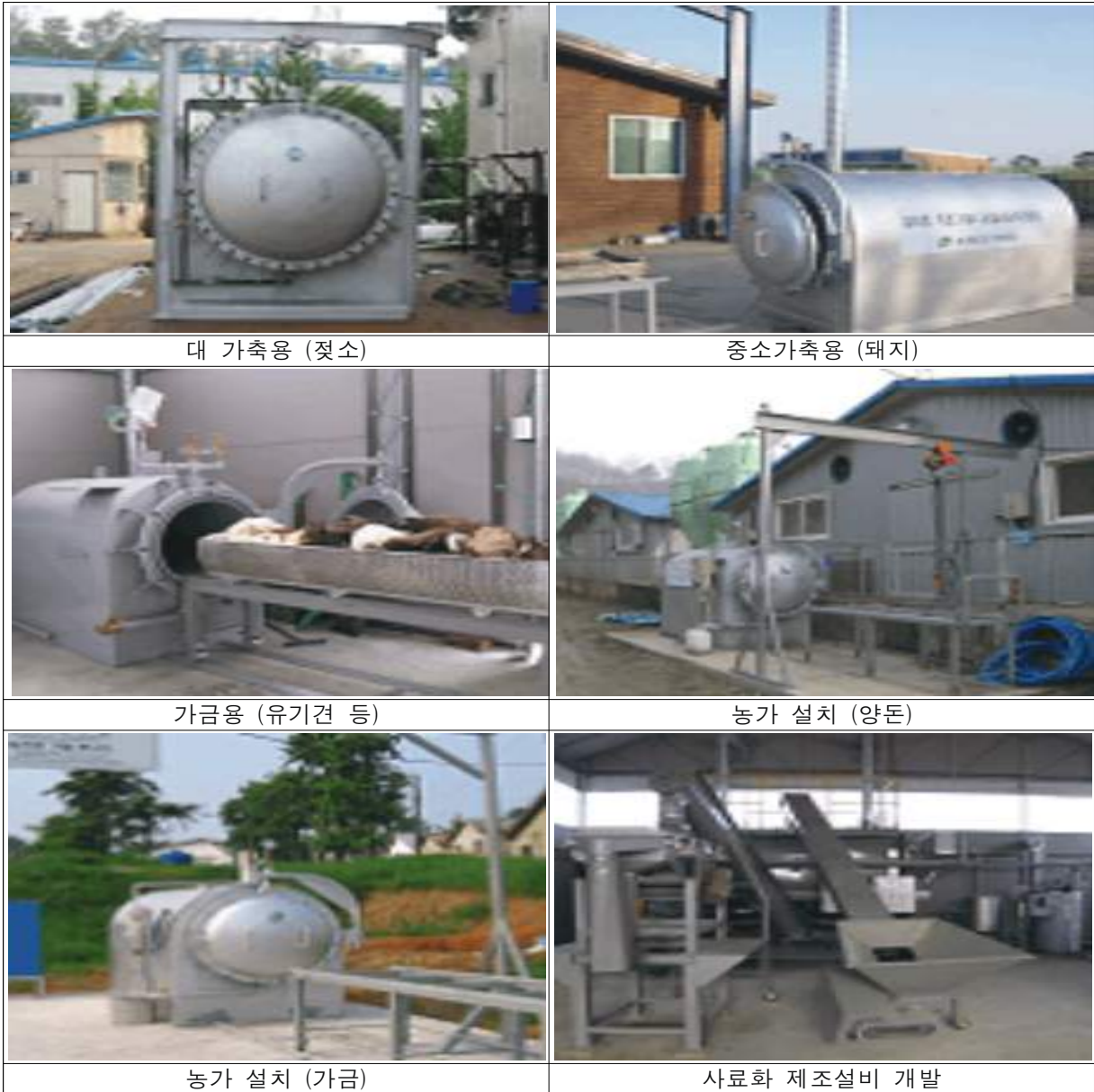
<그림 29> 가축의 크기에 따른 렌더링 장치와 농가 설치 사례
