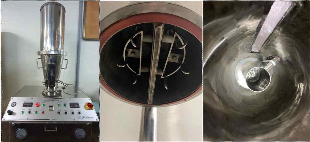
그림 21. 제작한 유동층 코팅기 및 트윈 휠터타입 챔버(chamber)
