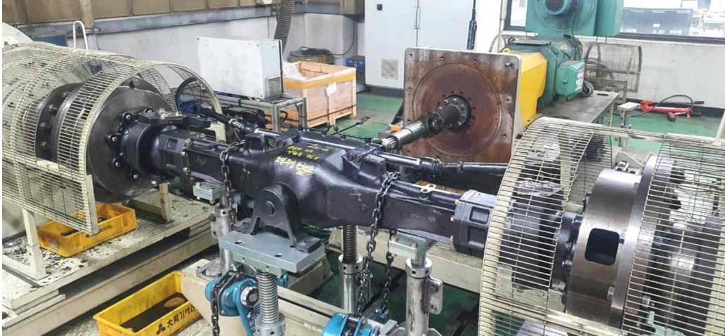
그림 141 최대차동잠금을 시험(샤시다이아모 활용)
