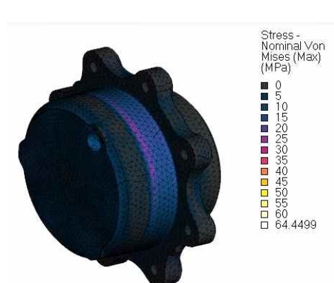
그림 83 유성 케리어의 Von-Mises stress 분포
