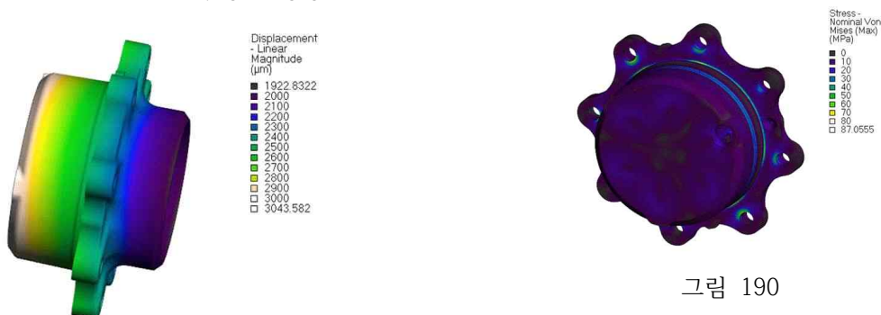
그림 188 스위블하우징의 Von-Mises stress 분포
