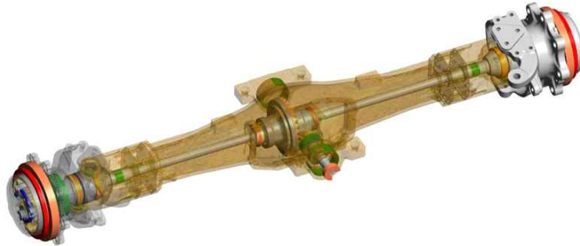
그림 217 Simulation model of tractor front axle
