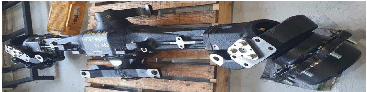
그림 102 공용화 앞차축 Proto(대동공업 기대 & 최대차동잠금을 시험 기대)
