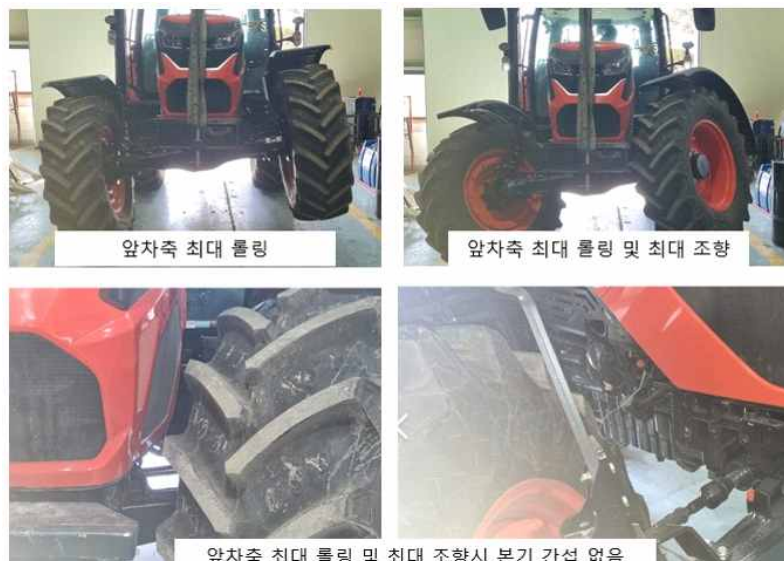
그림 200 앞차축 조향 및 Rolling 간섭여부 확인
