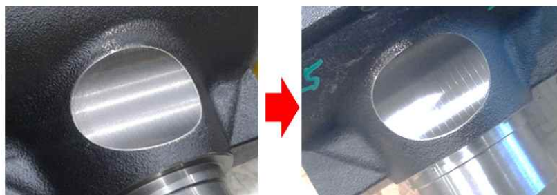
그림 193. 차동케이스 설계 변경(전 → 후)
