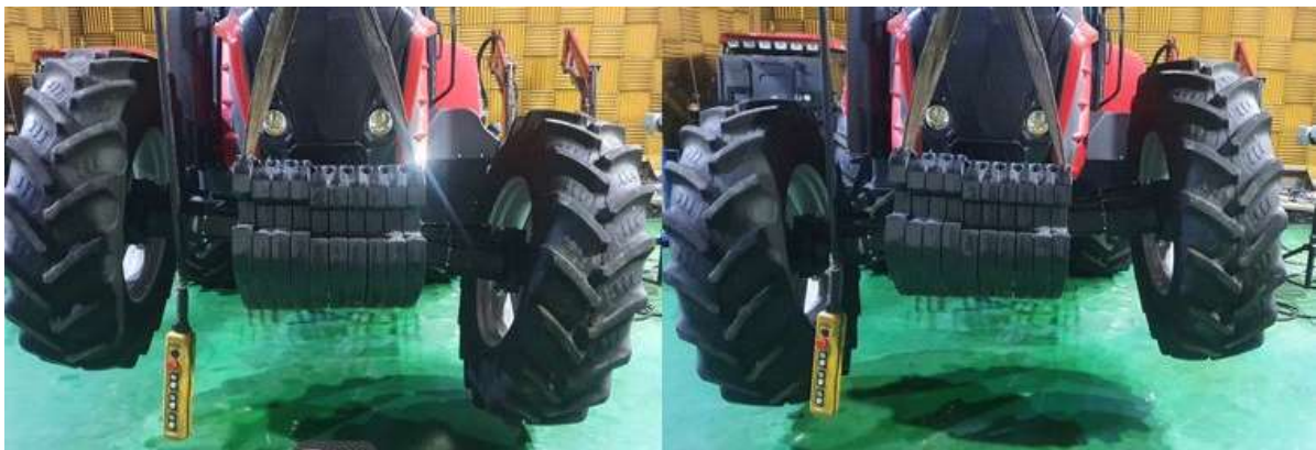
그림 206 앞차축 조향 및 Rolling 각 측정
