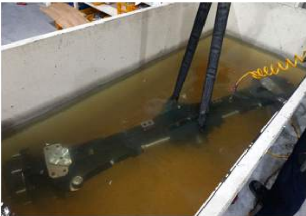
그림 194 공용화 앞차축 수압 및 모터링 테스트
