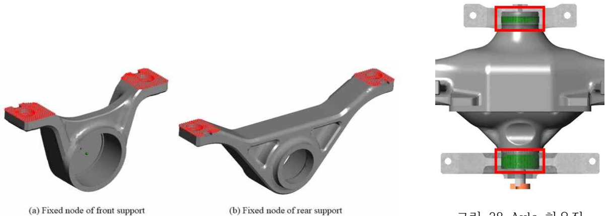
그림 38 Axle 하우징 경계조건
