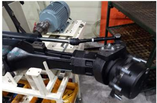
그림 194 공용화 앞차축 수압 및 모터링 테스트
