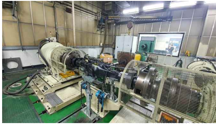
그림 210 최대차동잠금을 시험(샤시디어나모 활용)
