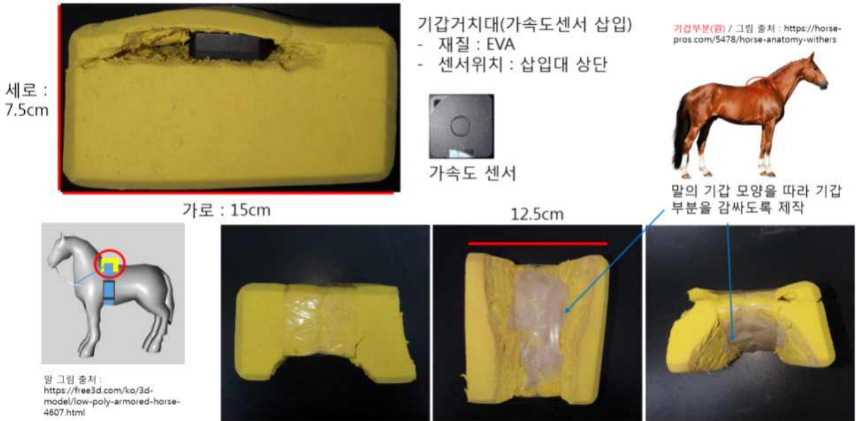
<그림 2-10> 가속도센서의 부착위치를 고정하기 위한 하우징과 복대
