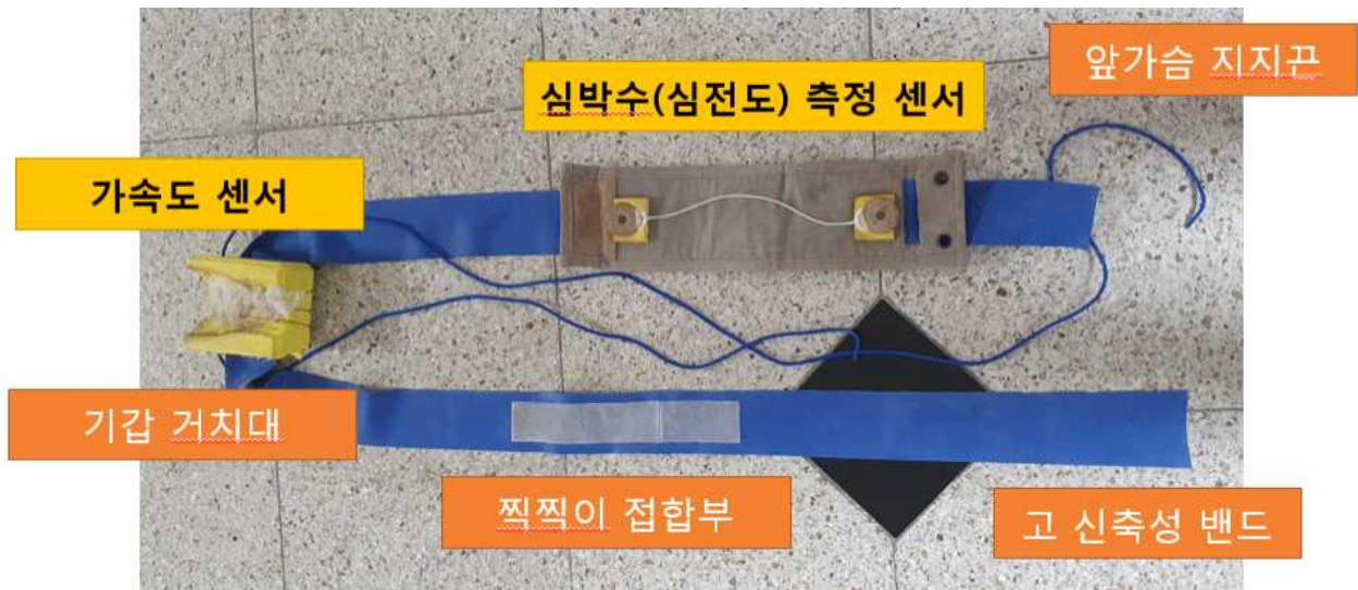
〈그림 2-9〉 말의 활동 및 개체정보 센서의 구성도
