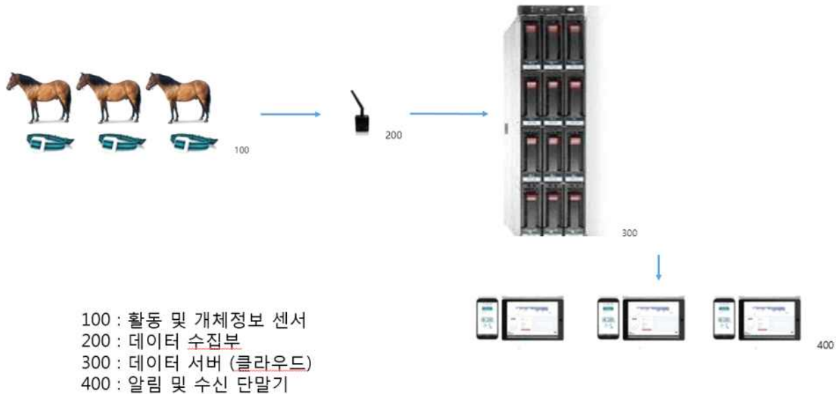
〈그림 2-8〉 말의 가속도 및 심전도 측정 시스템의 구성도
