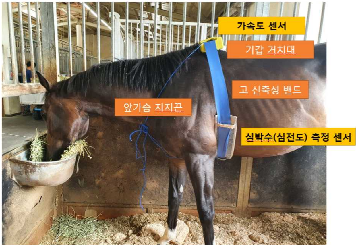
〈그림 2-13〉 가속도센서와 심전도센서를 복대 형태로 말에 착용한 모습
