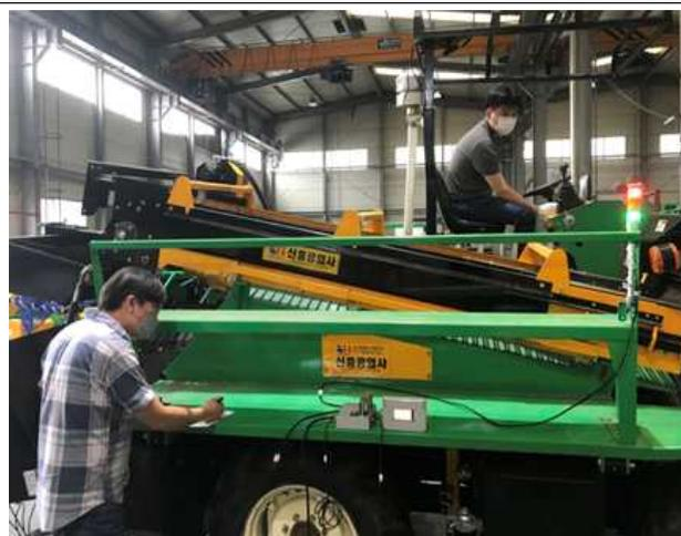
KCL 시험 담당자 입회 하에 전복 감지 시험 진행
