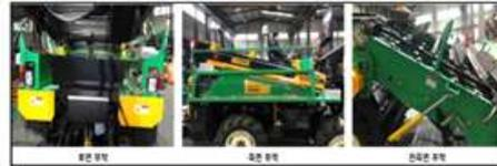
그림 5 자주식 수확기에 부착된 다기능 안전시스템
