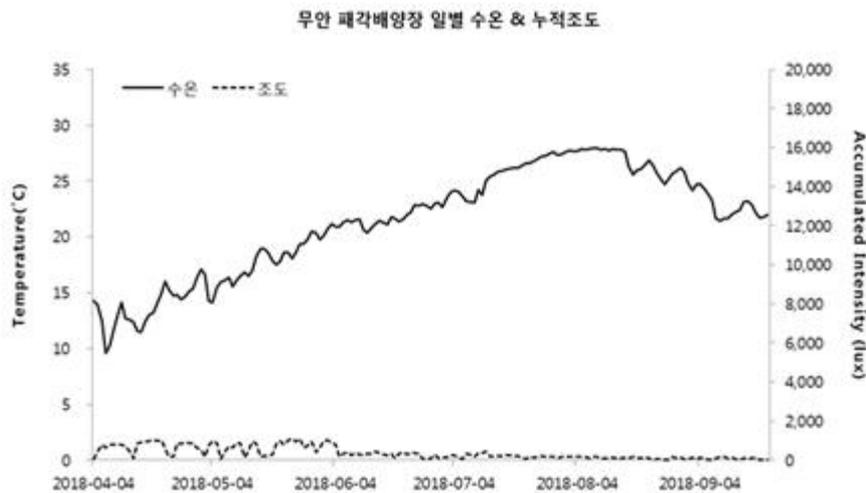
그림 56. 무안 패각배양장의 호보센서를 이용한 수온 및 조도 측정 결과.
