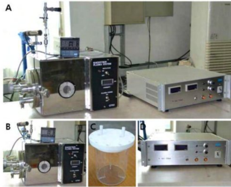
그림 3-21. 종자소독용 소형 저온플라즈마장비. (A) 장비 전경, (B) 플라즈마 발생 챔버, (C) 플라즈마 발생 챔버 내 유리 챔버, (D) 플라즈마 power 조절기
