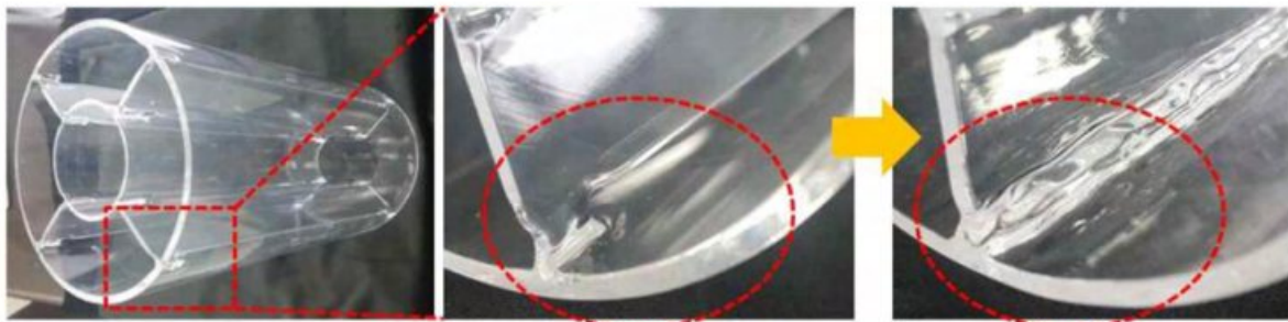
그림 3-61. 교반 반응기(오른쪽), 기존 반응기 내부 석영 구조(가운데)와 개선된 반응기 내부 석영 구조(왼쪽)
