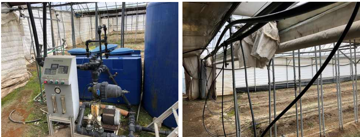
그림 62. 양액 공급을 위한 양액기(좌)와 보온 및 병해충 감염 예방을 위한 측벽 커튼(우)
