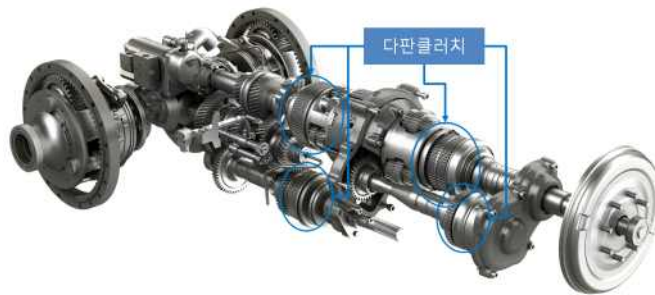
<그림 5> 자동변속 System 구조 예
