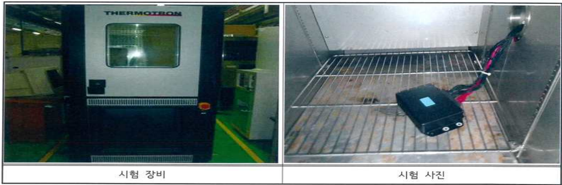
<그림 95> 저온작동시험 장비(좌) 및 시험 사진(우)
