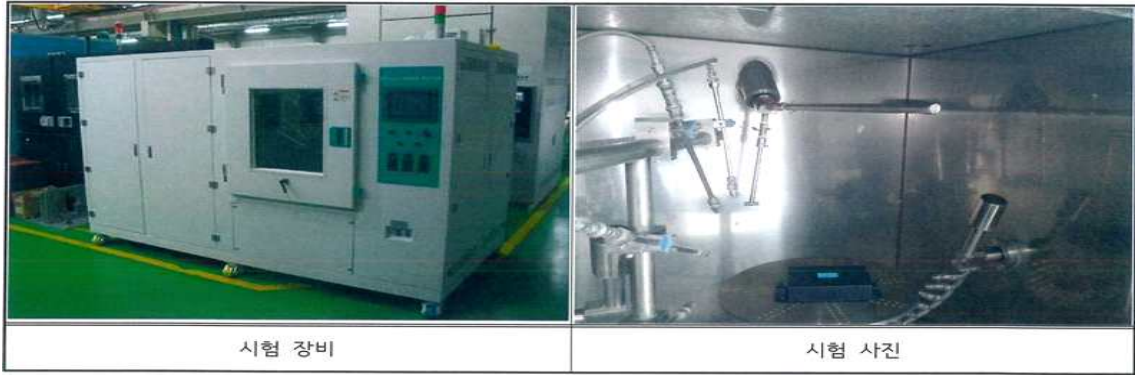
<그림 96> 살수시험 장비(좌) 및 시험 사진(우)
