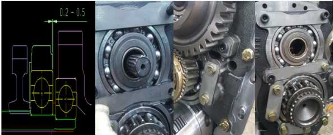
<그림 39> 베어링 잡이 설계 및 적용
