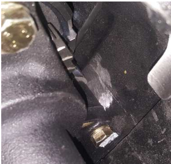
<그림 55> 4WD/QT커버 간섭 발생
