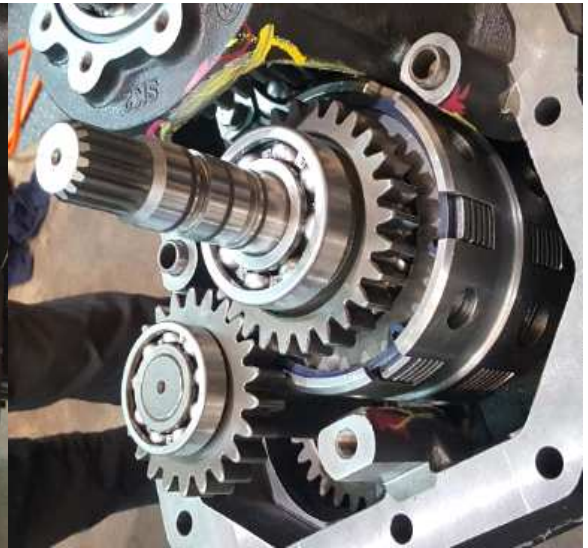
<그림 54> 중간케이스 재생 후 조립
