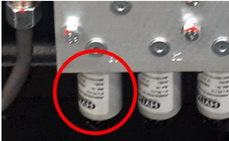
<그림 66> 1단 솔레노이드 밸브 오작동 발생
