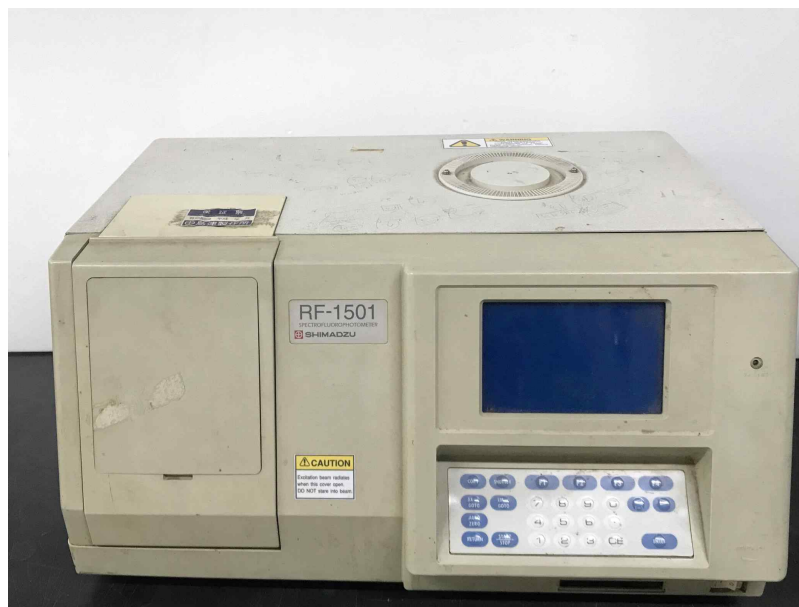
그림 1. Se을 측정하는 형광분도계
