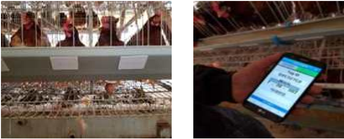
그림 16. RFID활용 산란 수 정보 수집 장치(좌: 케이지별 RFID 태그, 우: 정보 수집 장치)
