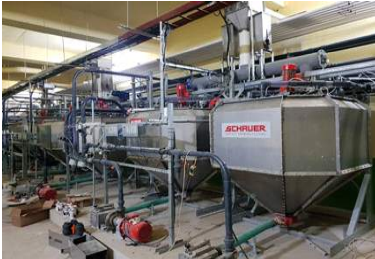
그림 1. 애니팜 영농조합법인에 설치되어 있는 양돈용 액상급이기
