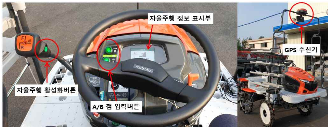
그림 86 Kubota KNW8-GS 기종의 자율주행 관련 조작부 배치현황
