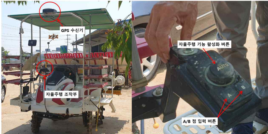
그림 87 Yanmar YR8D 기종의 자율주행 관련 조작부 배치현황
