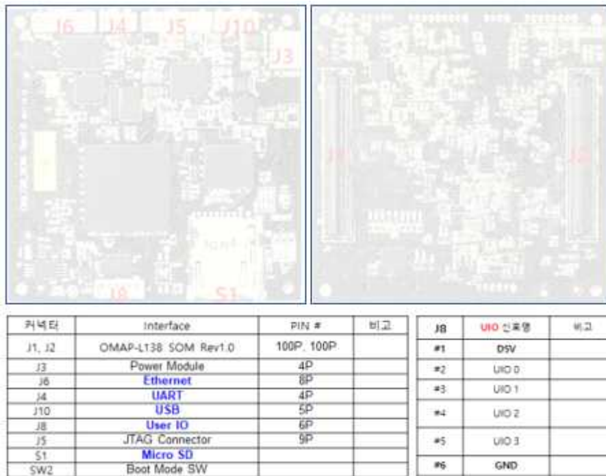
그림 98 멀티코어 MCU 보드 Lyout 및 신호 정의
