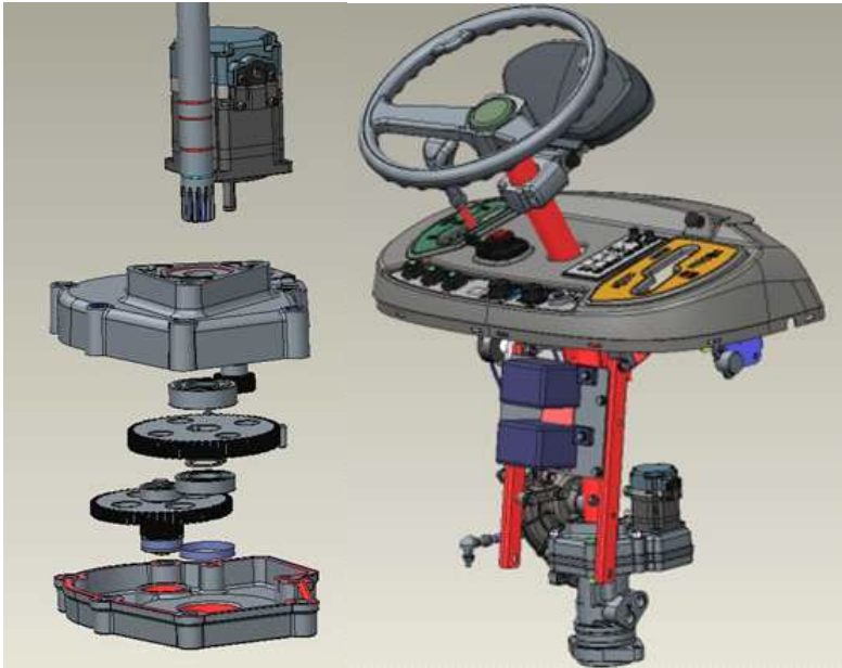
그림 78 개발 조향부 분해도 및 매칭 검토
