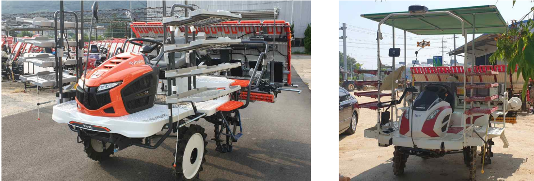
그림 85 국내 시판중인 일본 자율주행기능 탑재 이양기 (Kubota KNW8-GS(좌) / Yanmar YR8D(우))
