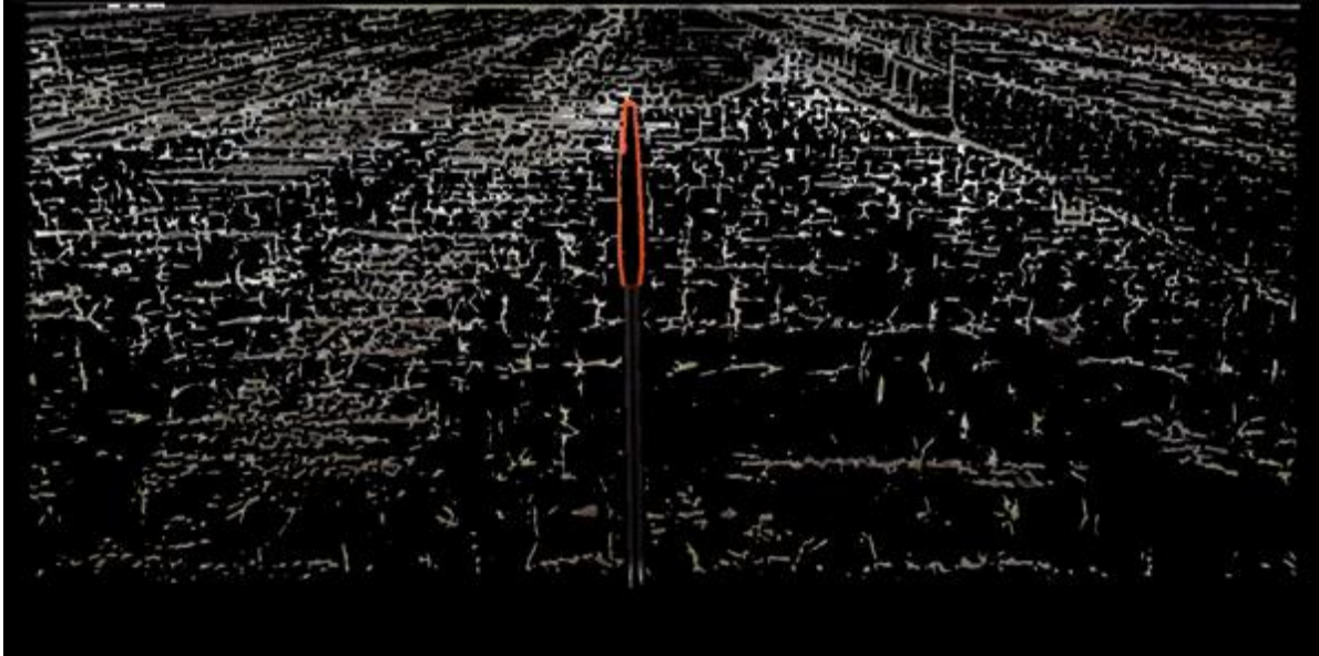
그림 174 색상필터적용-3 (Adaptive Threshold)
