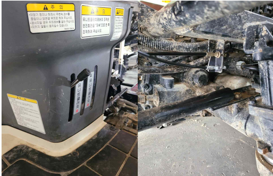
<레버 연동 엔진 RPM 시스템 확인>
