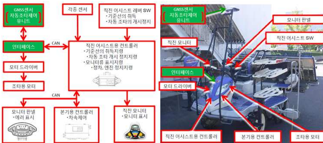
그림 72 I사 직진 어시스트 시스템 개요
