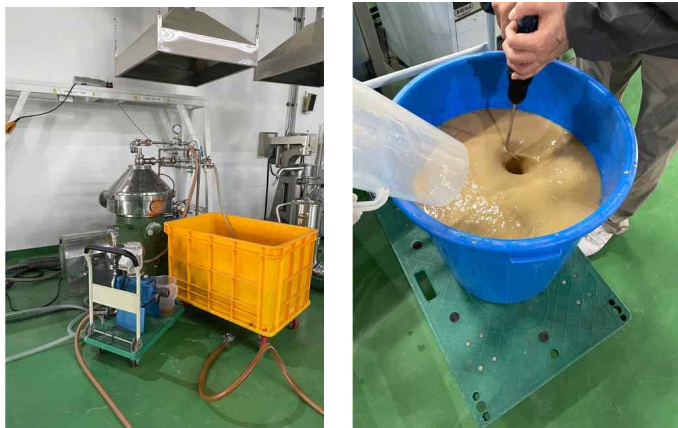
그림 4-26. 500리터 발효액의 연속식 원심분리(왼쪽)와 동결보호제 첨가후 사진(오른쪽)
