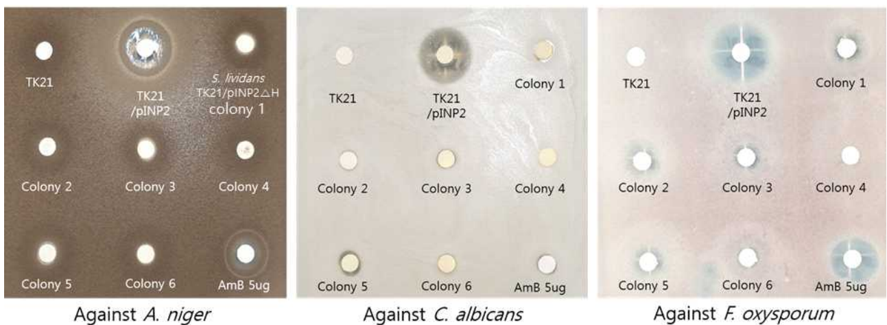
그림 3-6. INP2, INP2 aglycone 이중숙주발현 균주인 S. lividans TK21/pINP2, S. lividans TK21/pINP2ΔH (colony 1 ~ 6)의 항진균활성테스트
