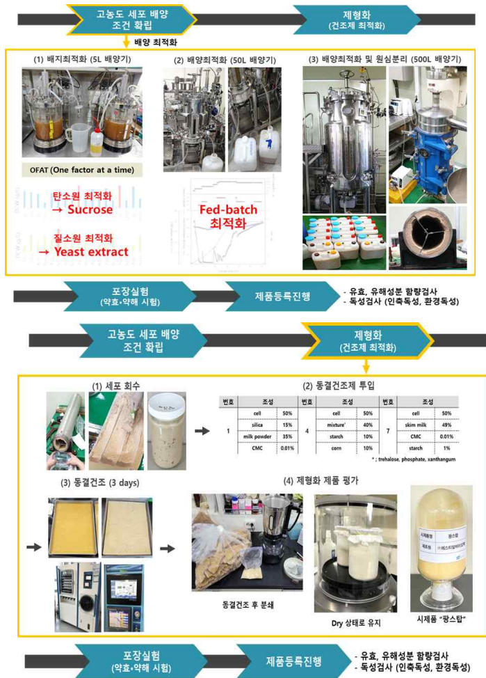
그림 4-29. 제품생산을 위한 전체 배양공정과 분리정제 공정의 모식도
