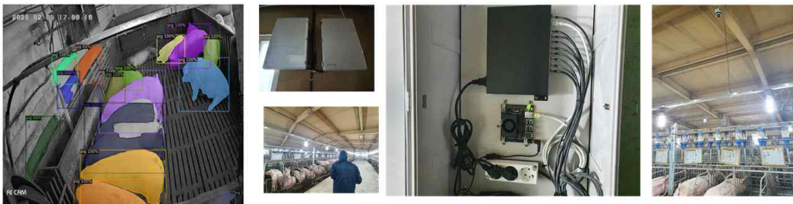
[그림] 양돈객체검출 데이터셋 및 이를 학습한 모델을 내제화 한 엣지컴퓨팅 박스 (에스엘축산영농조합법인 산하 양돈농장 모돈사에 설치 및 실증 진행 중)
