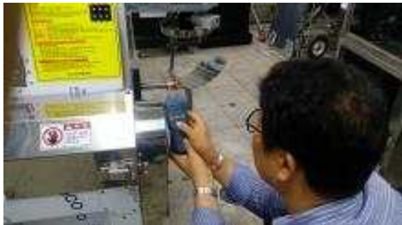
<그림> 박피 홀더의 주축과 꼭지 탈피기의 rpm 측정 및 Torque 산출
