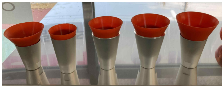
<그림> 감의 크기 및 종류에 따른 흡입 장치 실물
