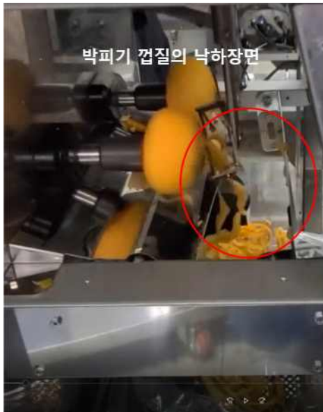
<그림> 감 박피 껍질(좌측)과 감의 이동(우측) 컨베이어 장치(2차개선)
