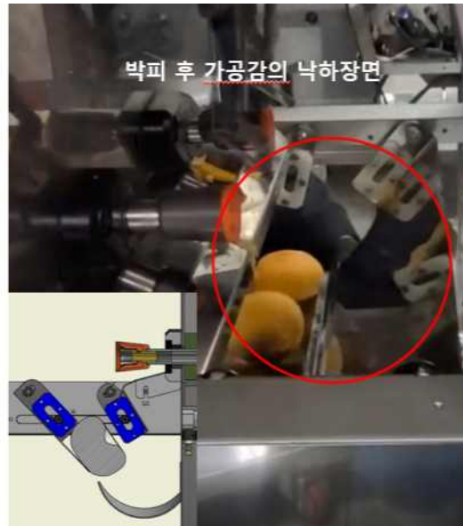
<그림> 감 박피 껍질(좌측)과 감의 이동(우측) 컨베이어 장치(2차개선)
