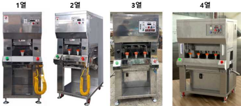
<그림> 1열, 2열, 3열, 4열 자동 감 박피기 시제품 개발
