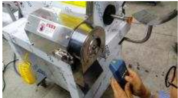
<그림> 박피 홀더의 주축과 꼭지 탈피기의 rpm 측정 및 Torque 산출
