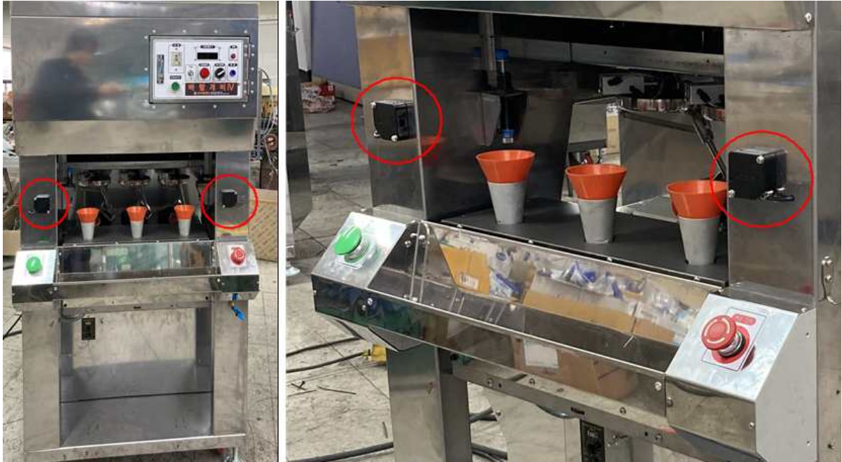
<그림> Photo sensor를 이용한 안전센서
