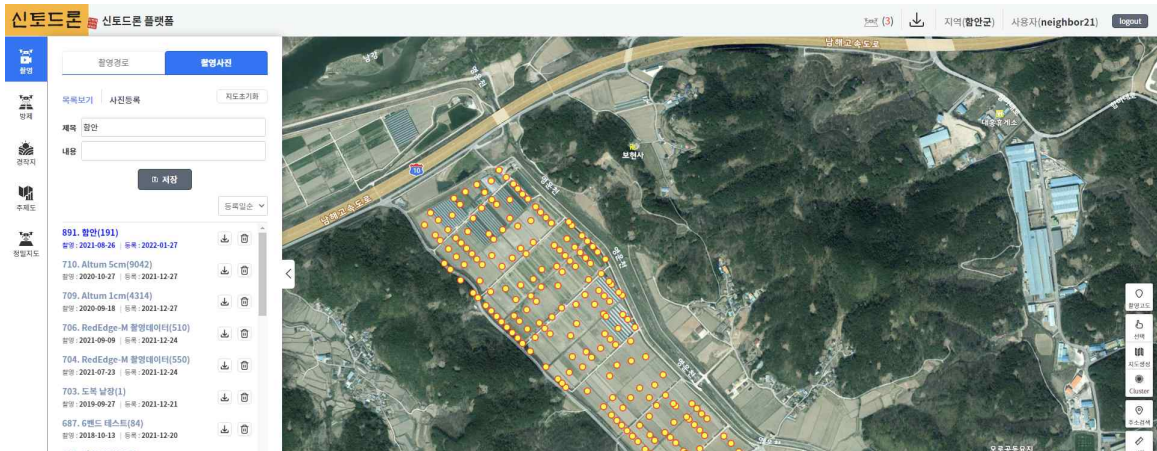
< 드론 촬영 사진 업로드 후 촬영 위치/정보 확인 >
