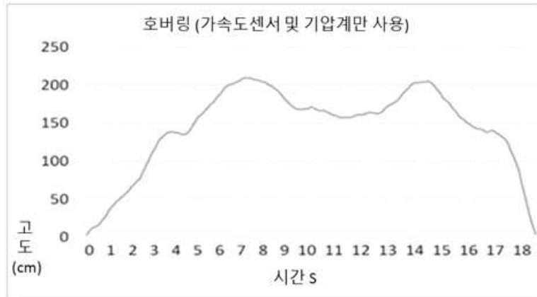
< 호버링 고도 측정 - 가속도 센서 + 기압계 센서 >
