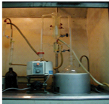
[그림 2-4-15] 연속수증기증류추출법에 의한 휘발성 유기성분 추출
