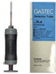
[그림 2-5-16] 기체 채취기 GV-100S (GASTEC Corporation, Japan) 및 Ammonia detector tube 3La (GASTEC Corporation, Japan)
