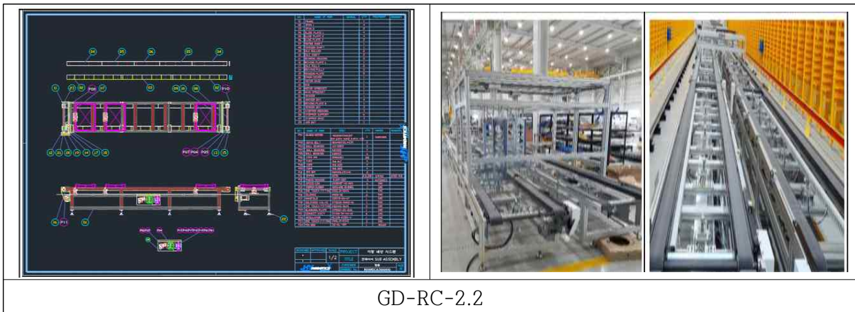
[Figure.11] 컨베이어 주요부 명칭 및 부품 리스트.
