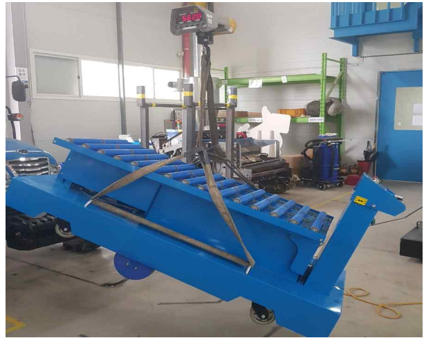
(b) 로봇 플랫폼 무게 측정(562Kg)
