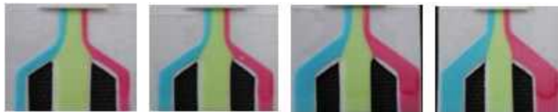
[서로 다른 사이즈로 patterning 된 membrane에서의 flow 확인 결과]
