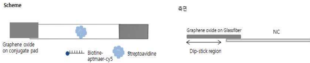
[Dip-stick 형태의 농약스트립센서 모식도]
