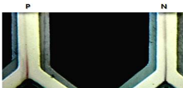
[효소를 이용한 농약 검출 결과, P : Malaoxon 100ppb in MeOH, N : MeOH]
