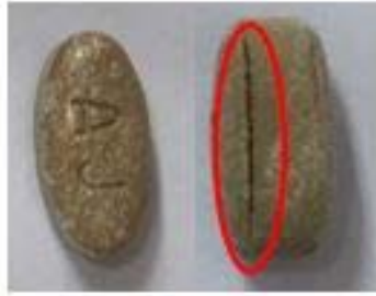
그림 29. Capping 현상 발생
