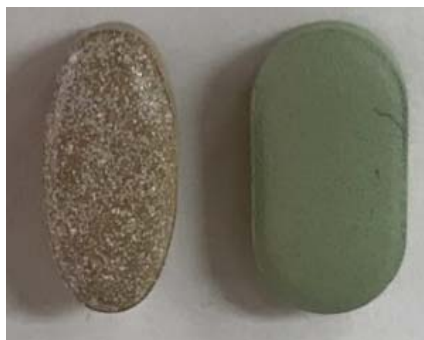
그림 28. 정제 성상 비교 (왼쪽 : 단축 (7.5mm) , 오른쪽 : 단축 (8.0mm))
