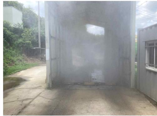
[그림 17] 정상 작동하나 실제 소독 효능은 없는 것으로 확인된 차량 소독기
