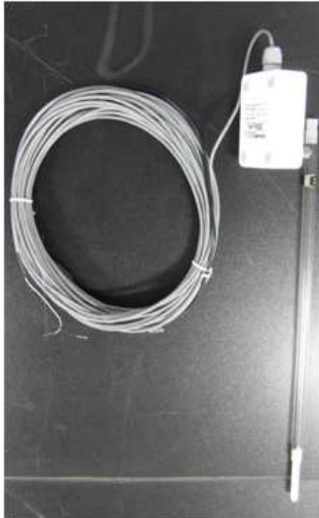
그림 2-59. Tensiometer tested in the experiment
