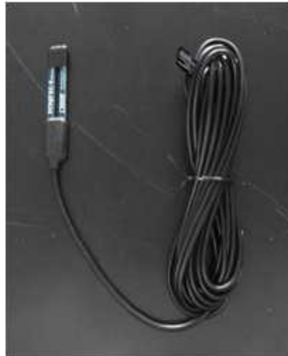
그림 2-60. ECH 2 O EC-5 Moisture Sensor tested in the experiment
