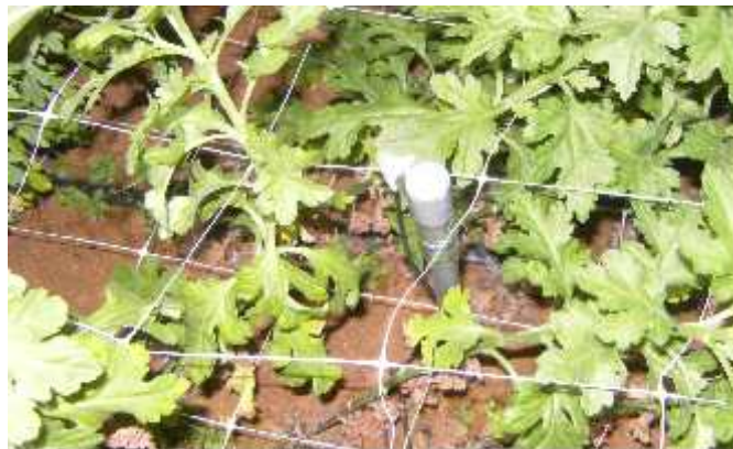
그림 2-9. 국화 실험장에 설치된 ZField 와 센서
