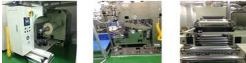
Unwinder 부분 Coating 부분 Rewinder 부분
