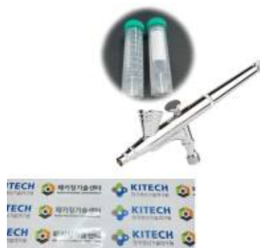
<그림 17 스프레이 코팅을 통해 고려대 코팅액 적용 필름 제조 개략도>
