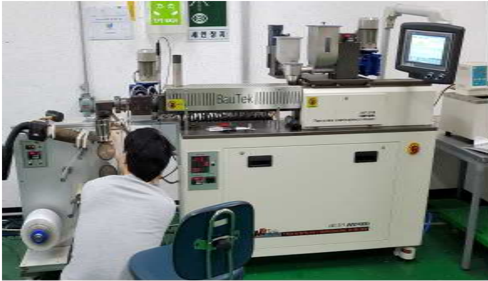
<그림 14 울촌화학 pilot scale 압출기를 통한 필름 생산>
