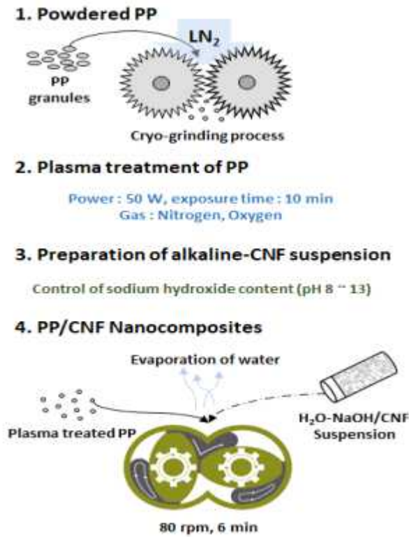
<그림 15 PP/CNF 복합소재의 시제품 제작 도식도>
