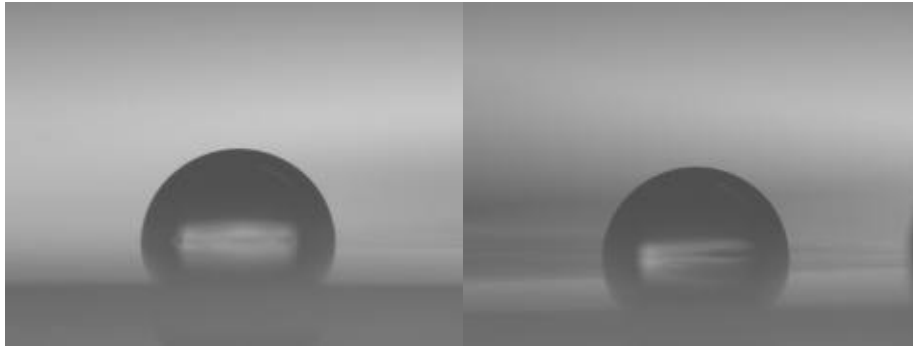
<그림 8 300x600으로 이축연신한 PP(좌)와 PP/nanoclay 6.4wt% 나노복합소재(우)의 접촉각 비교>
