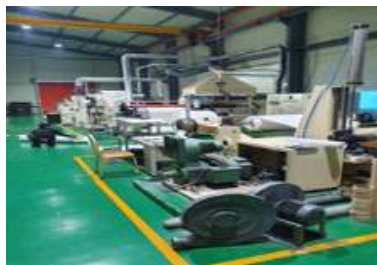
<그림15. 양산 scale 압출코팅 종이 제조 설비>
