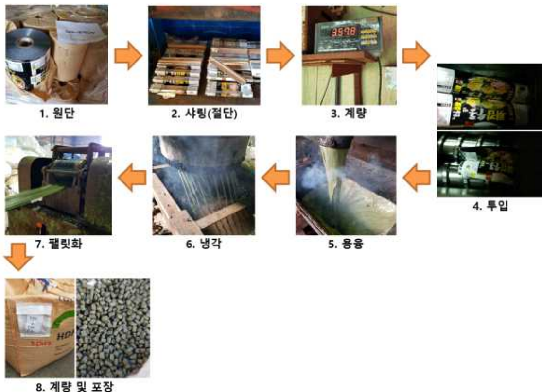
유당면 포장재 및 멀티팩 포장재 실험 과정 (OPP/CPP & OPP/AlvmCPP)
