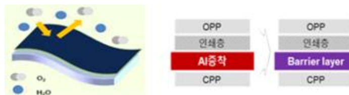
<그림1. Wet barrier BOPP film 구조 및 포장재 시제품 구성>
