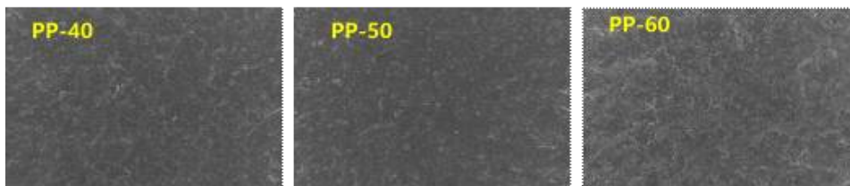
<그림16. 내열성 무기물 충전 고분자 복합체 코팅종이의 코팅층에 대한 SEM 분석>
