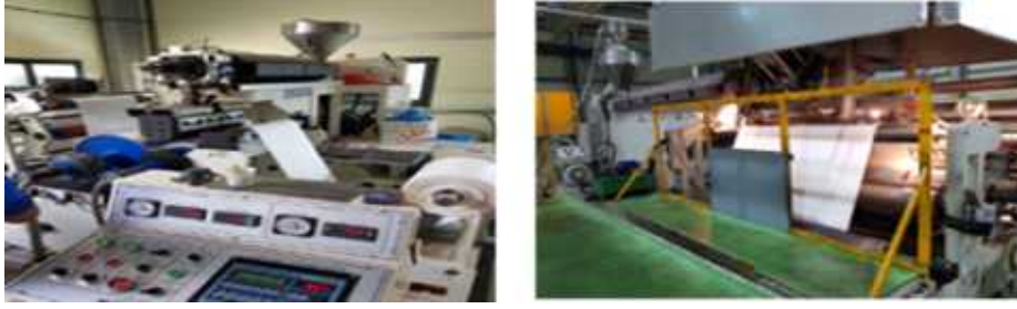
<그림6. Pilot scale 압출코팅 종이 제조 설비 양산 scale 압출코팅 종이 제조 설비>
