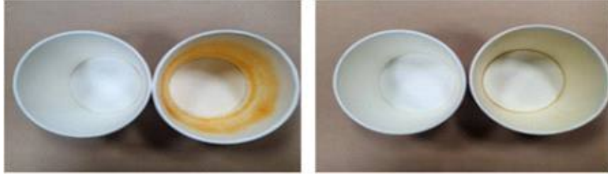
[ 종래 PE 코팅종이 용기 ] [ 무기물 충전 고분자복합체 코팅종이 용기 ] <그림21. 전자레인지 요리 전후 국물 뱀 상태 비교>
