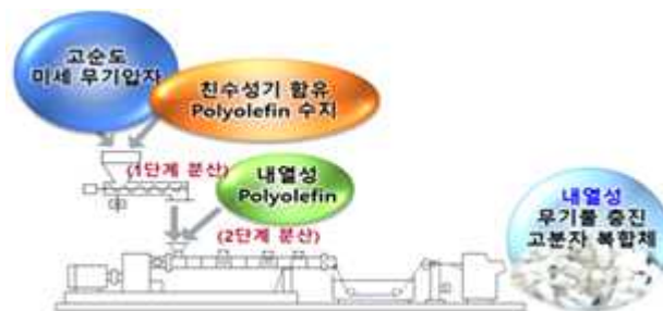
<그림10. 내열성 무기물 충전 고분자 복합체 제조공정>
