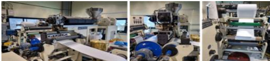
<그림14. Pilot scale 압출코팅 종이 제조 설비>
