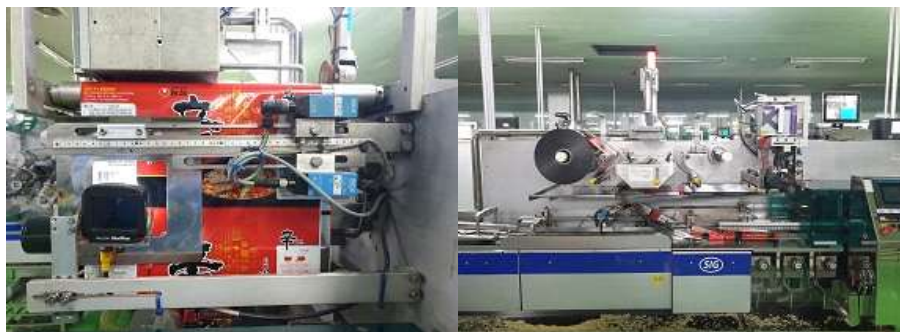
<그림 8 유탕면 포장재 1차 시제품 씰링성 및 생산 속도 평가 사진>
