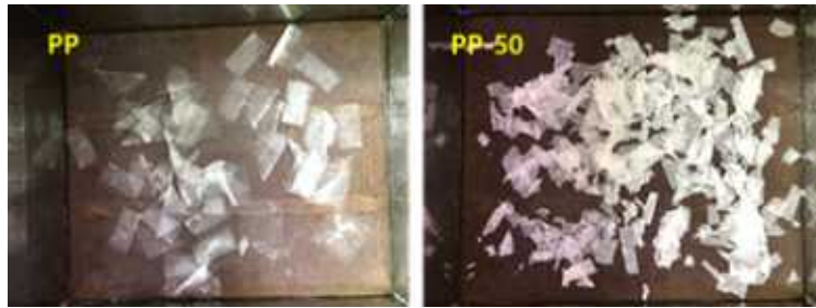
<그림23. PP 및 내열성 무기물 충전 고분자복합체(PP-50) 코팅종이에 대한 재활용성 평가>
