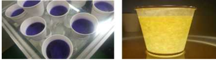
<그림9. HDPE/CaCO 3 복합체(=60/40) 종이컵 방수성 및 내유성 평가>
