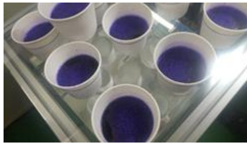
<그림19. 무기물 충전 고분자 복합체(PP-50) 코팅종이로 성형한 용기 샘플 방수성 평가>
