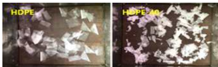
<그림11. HDPE 및 HDPE/CaCO 3 (=60/40) 복합체(HDPE-40) 코팅종이에 대한 재활용성 평가>
