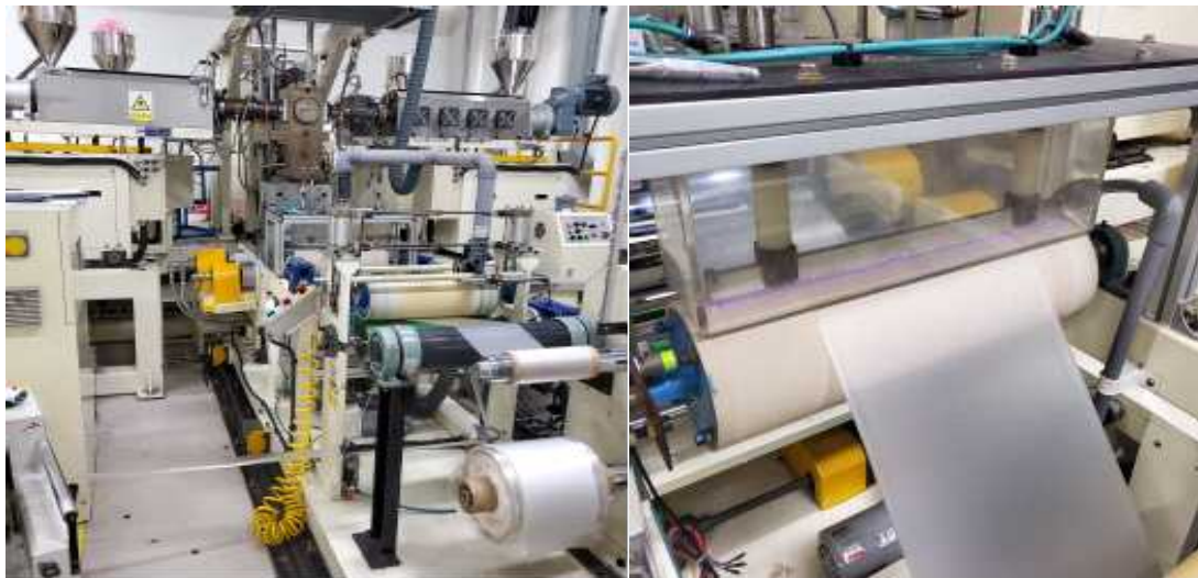
<그림 15 한국생산기술연구원의 pilot scale 압출기를 통한 필름 생산>
