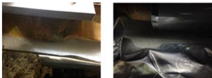
<그림4. Coating Head 부분 기포 과도한 발생(코팅 불량 원인)>
