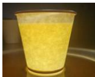
<그림20. 무기물 충전 고분자 복합체(PP-50)코팅종이로 성형한 용기 샘플 내유성 평가>
