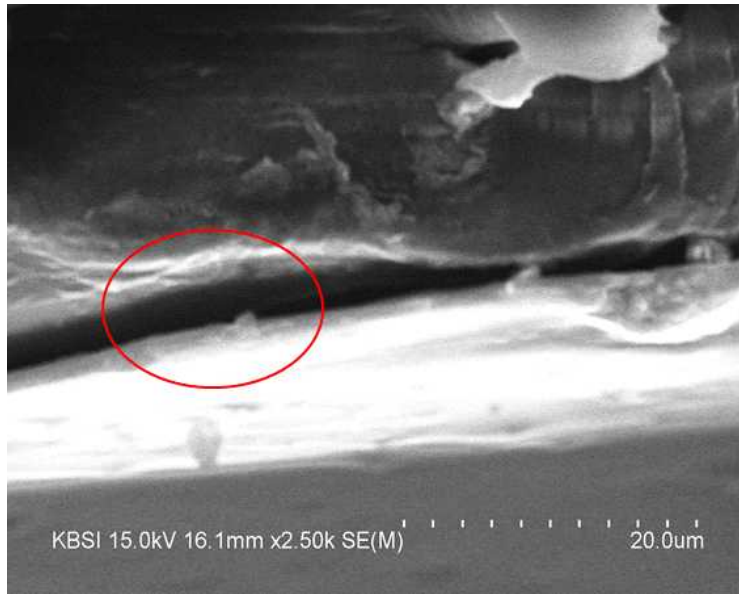
<그림 49> 비코로나면에 코팅된 PVA/BA/LDH 코팅필름의 단면 SEM 사진. 위는 PP, 아래는 코팅면
