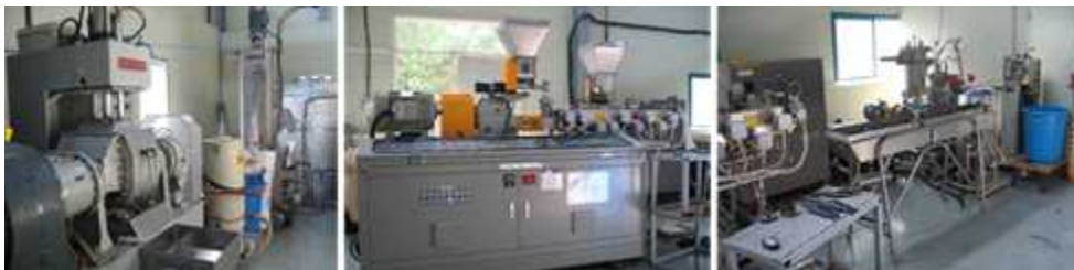
<그림11. Pilot scale 내열성 무기물 충전 고분자 복합체 제조>
