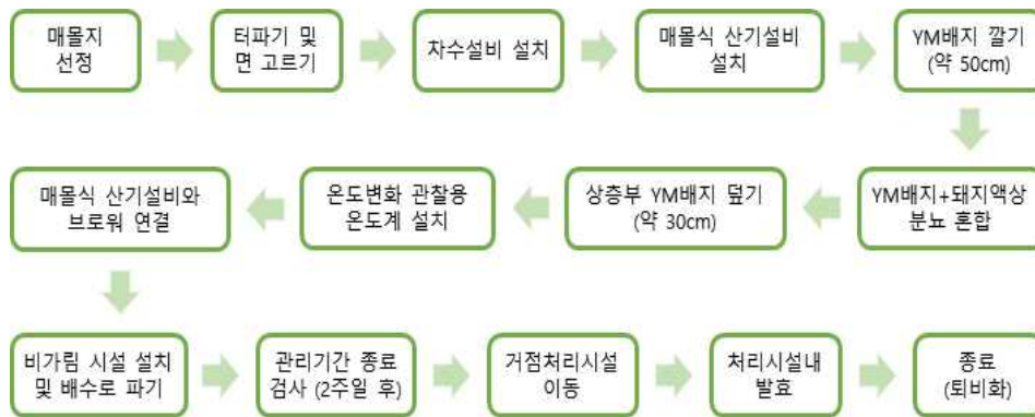
그림 89. 초고온 미생물을 이용한 돼지 액상분뇨처리 절차도
