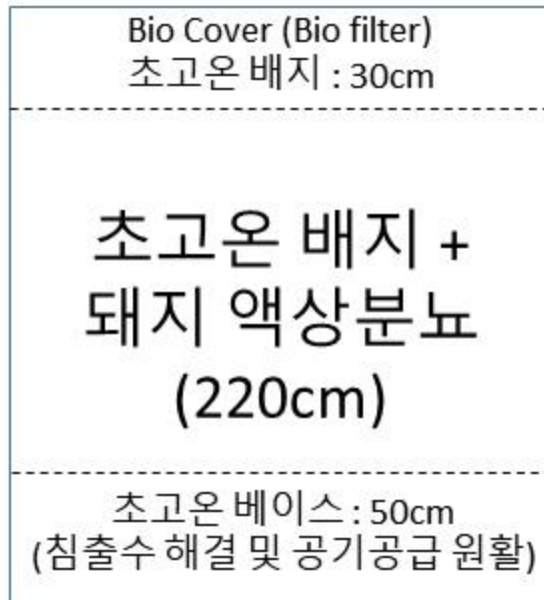
그림 90. 초고온 미생물을 이용한 돼지 액상분뇨처리 표준매몰 구상도 (매몰깊이 : 3m)
