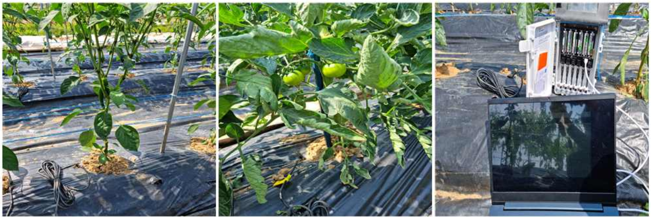
그림 118. 토양 수분 센서(EC-5)를 통한 토양 수분 변화 측정
