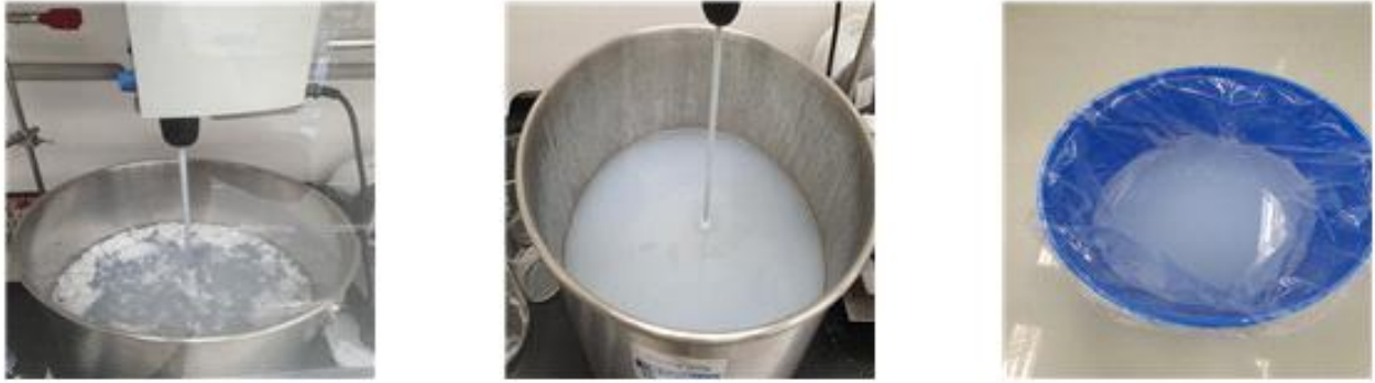
그림 9. 입자형 하이드로겔 제조(라포나이트 분산(좌), 개시제 및 촉매 첨가(가운데), 24시간 가교(우))
