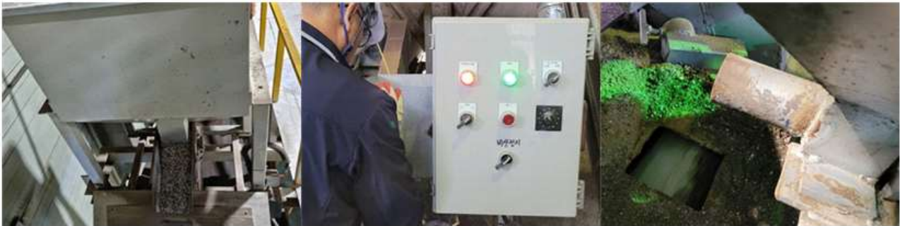
그림 109. 상토 및 부숙유기질비료(퇴비) 생산 라인에서 다기능 하이드로겔을 투입하기 위한 장비
