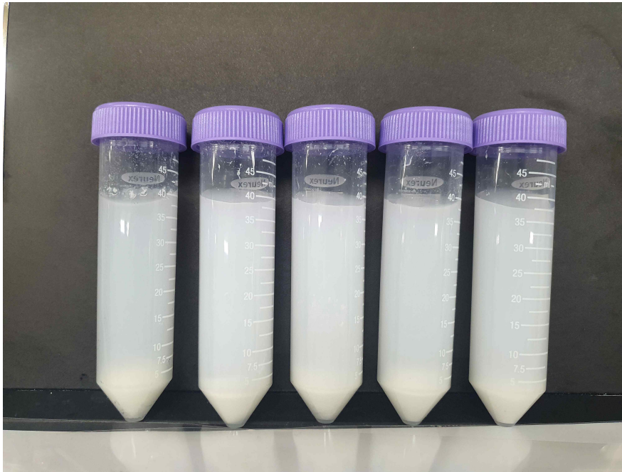
그림 128. 두 이온성 Polymer의 Self-assembly 과정을 통해 형성된 이온성 하이드로겔
