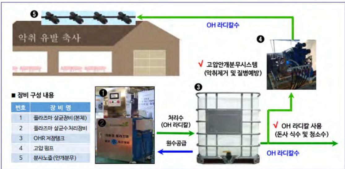
(그림 78) 돈사 약취제거 시스템\_안개분무적용
