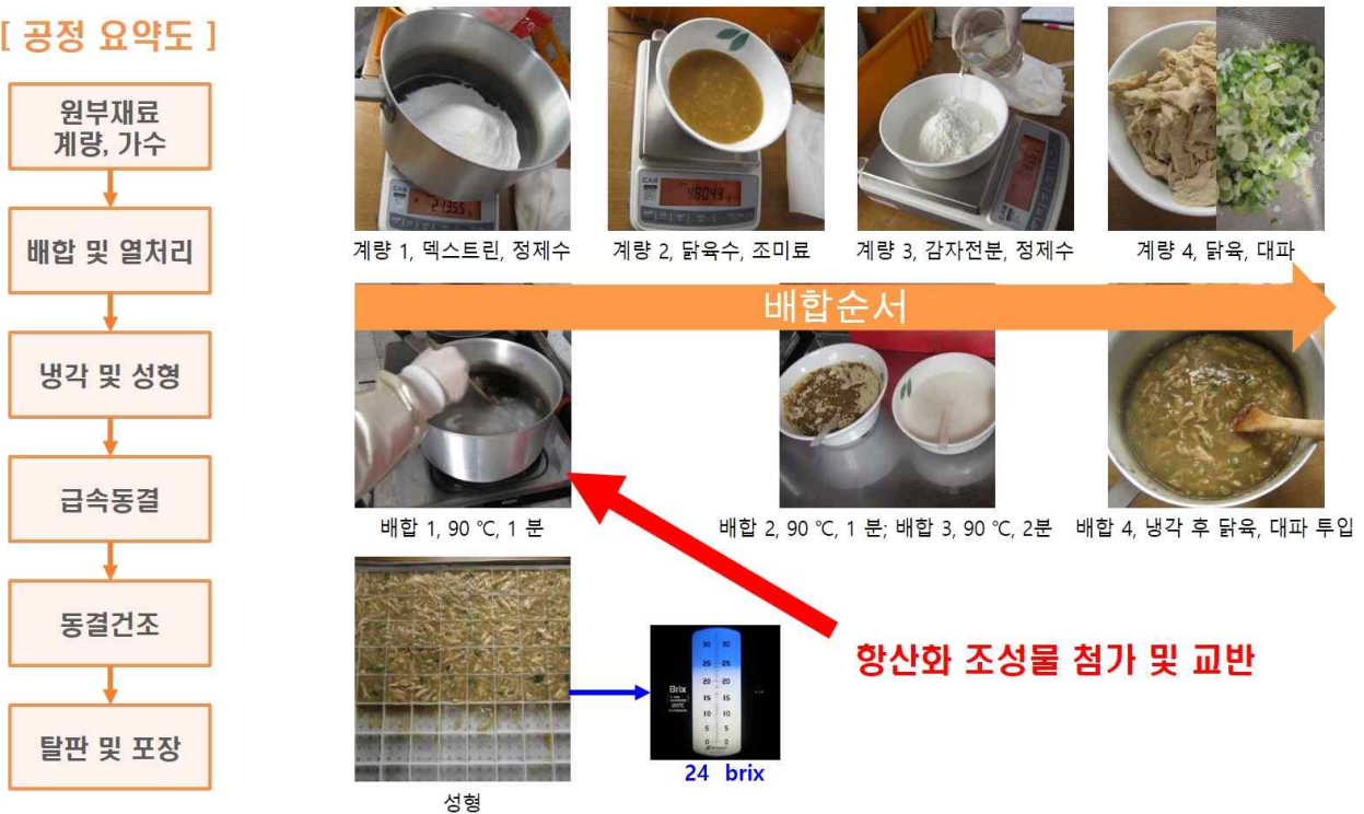
[ 그림 24 ] 향산화 조성물을 적용하기 위한 동결건조 삼계탕 블록제품 제조공정도 및 시제품 제작 사진
