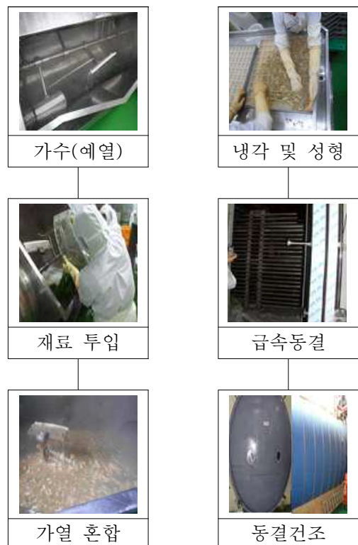
[ 그림 10 ] 파일럿 규모 동결건조 삼계탕 블록 제품 제작 재현시험
