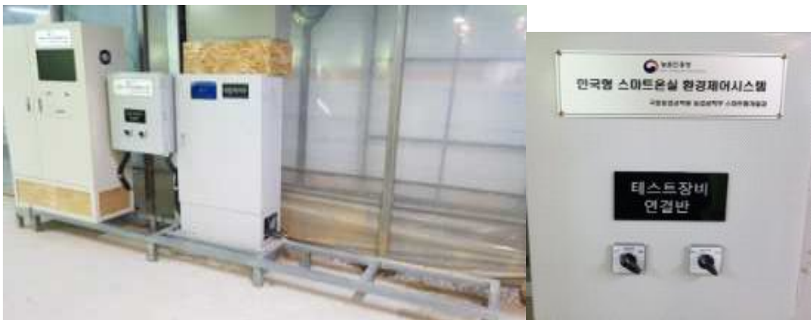
그림 84) 스마트온실 환경제어기 테스트 장비 연결 시스템
