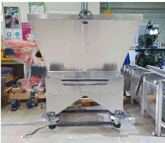
그림 71 오리사 바닥 깔짚 자동 관리장치 제작 현장(하우스형 농장용)
