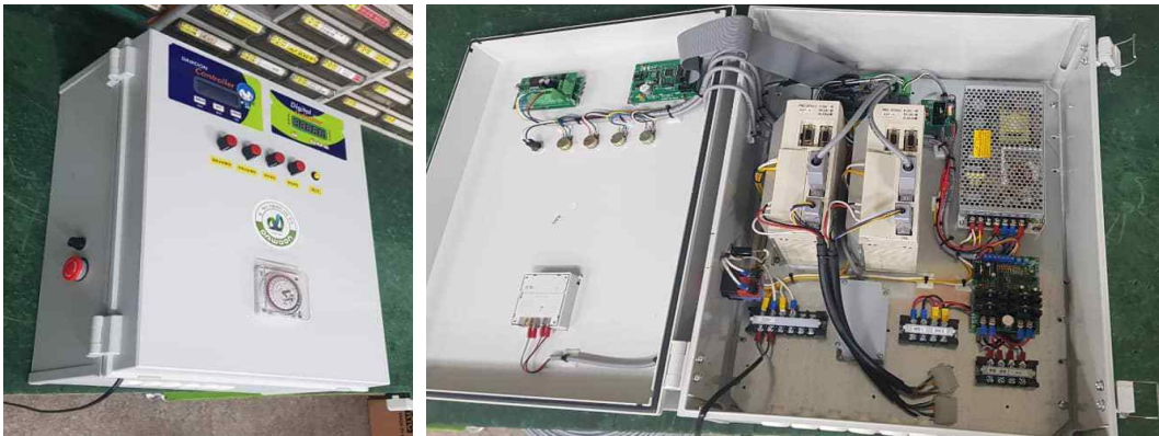
그림 64 오리사 바닥 깔짚 살포장치 제어기 제작
