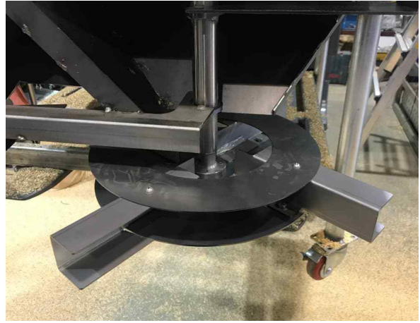
그림 24 깔짚 이송 컨베이어 및 살포 블레이드 1차 제작품의 살포부
