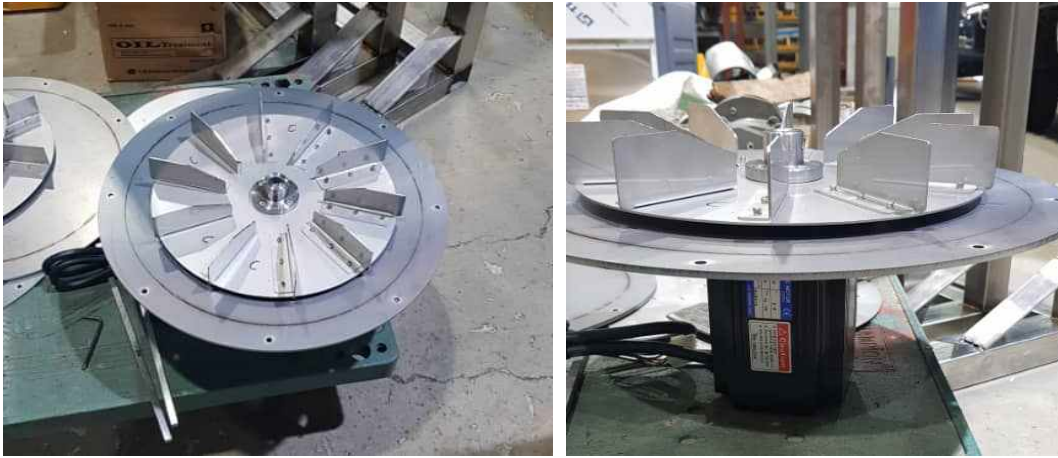
그림 63 깔짚 살포용 회전 블레이드 제작
