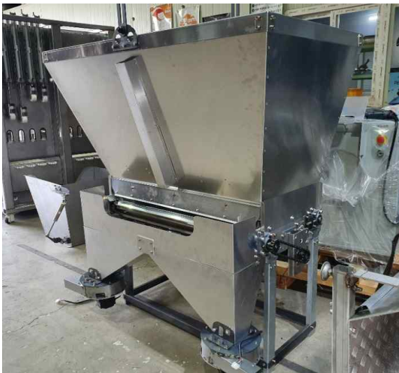
그림 70 챔버부 상부 제작 진행(하우스형 농장용)
