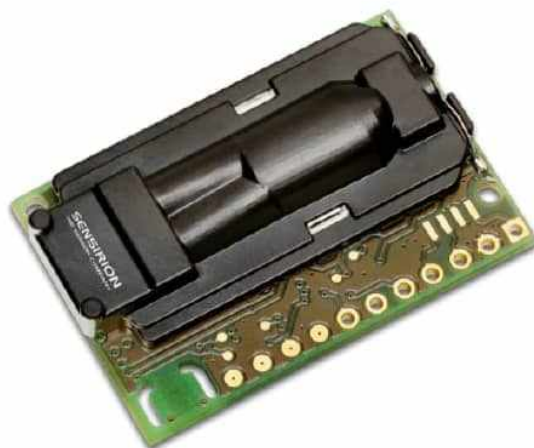
그림 89 온도, 습도, 이산화탄소 센서 모듈
