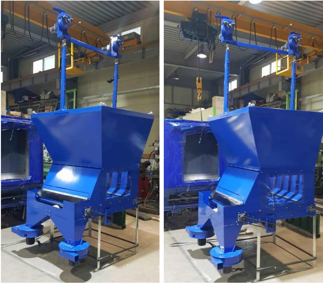
그림 66 오리사 바닥 깔짚 살포장치 조립, 분체 도장 후 상태
