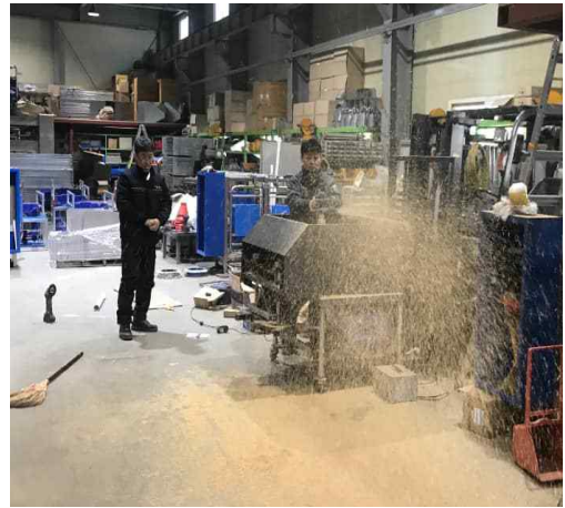
그림 24 깔짚 이송 컨베이어 및 살포 블레이드 1차 제작품의 살포부
