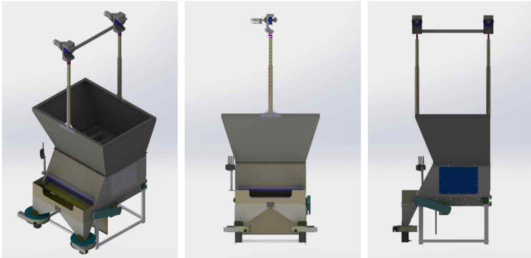
그림 31 바다 깔짚 자동 살포장치 3D 설계도(일반 농장용)
