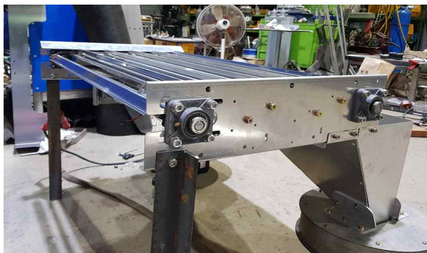
그림 62 갈짚 살포부 제작품, 분체도장 전 상태
