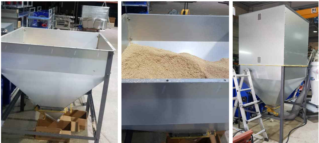
그림 69 깔짚 선적 장치 제작 및 선적 테스트 수행
