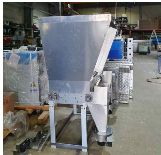
그림 71 오리사 바닥 깔짚 자동 관리장치 제작 현장(하우스형 농장용)
