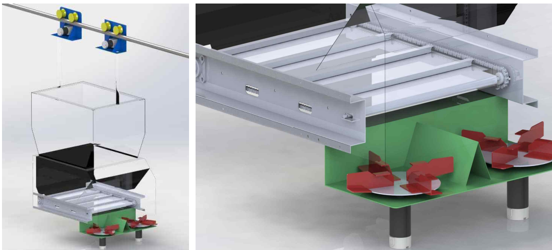
그림 10 2세트 블레이드를 추가한 오리사 바닥 깔짚 살포 장치 설계
