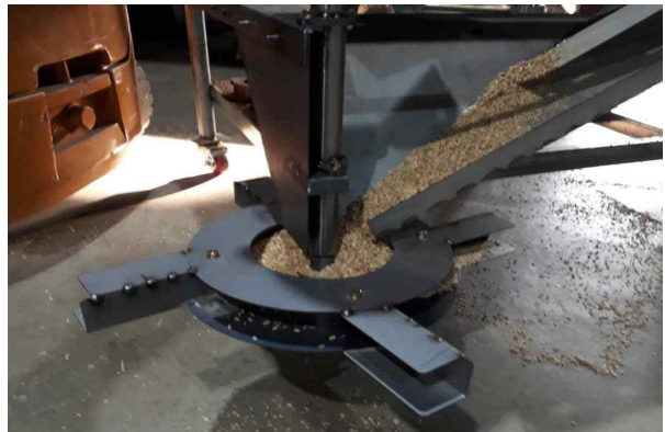
그림 25 깔짚 이송 컨베이어 및 살포 블레이드 1차 제작품 살포 능력 시험
