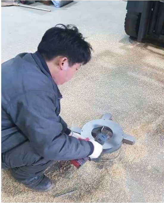
그림 26 다양한 날개형상 및 분사방법 테스트
