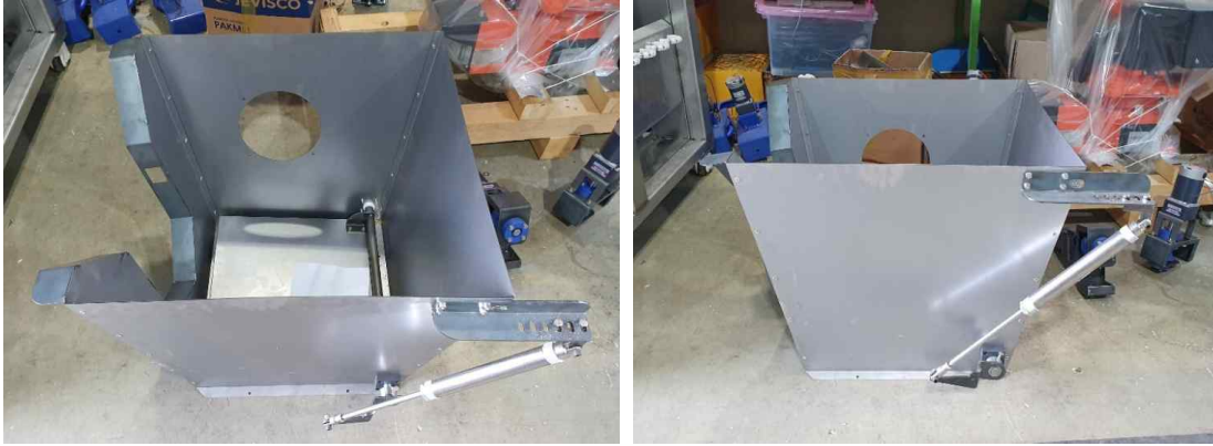
그림 70 챔버부 상부 제작 진행(하우스형 농장용)
