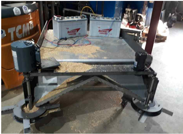
그림 24 깔짚 이송 컨베이어 및 살포 블레이드 1차 제작품의 살포부
