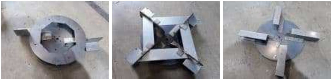
그림 22 깔짚 살포 블레이드 테스트 모델
