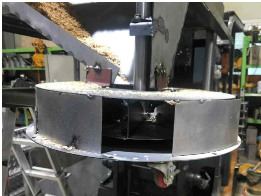
그림 25 깔짚 이송 컨베이어 및 살포 블레이드 1차 제작품 살포 능력 시험
