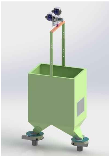
그림 32 하우스형 오리사용 경량화 모델 설계도 초기(3D 등각도)
