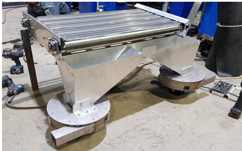
그림 61 갈짚 보관 호퍼(상부 챔버) 제작품, 분체도장 전 상태
