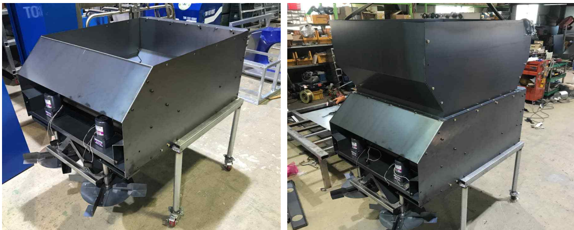
그림 23 깔짚 이송 컨베이어 및 살포 블레이드 1차 제작품 완성
