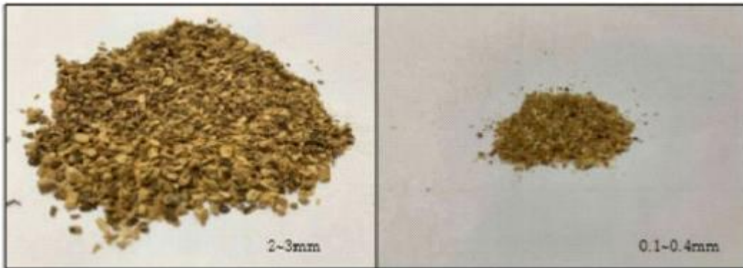
<그림 7> 분체선별기에 의해 선별된 분쇄약재(좌) 및 미세분말(우)의 모습
