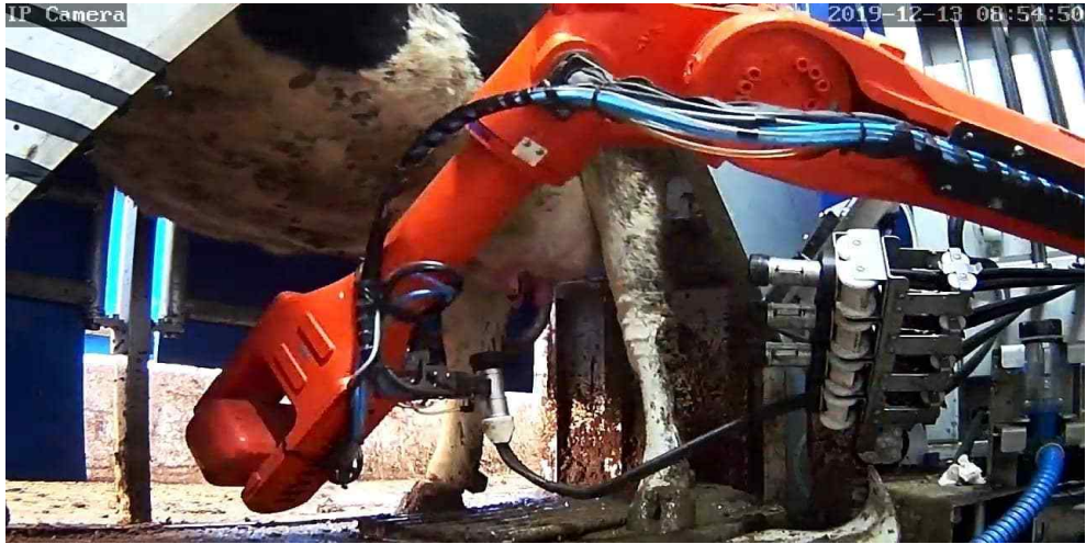
그림 222 착유과정② 로봇 ARM이 착유컵을 그립(grip), 젖소의 하단으로 착유컵 이동
