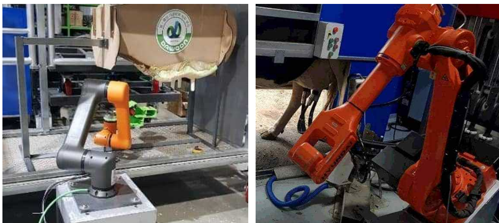
그림 53 산업용 로봇 매니플레이터 모델 변경 전 1호기(좌), 변경 후 2호기(우)
