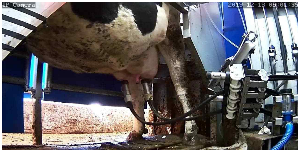
그림 232 착유과정② 착유컵 2개째 자동 탈락 및 자동 복귀
