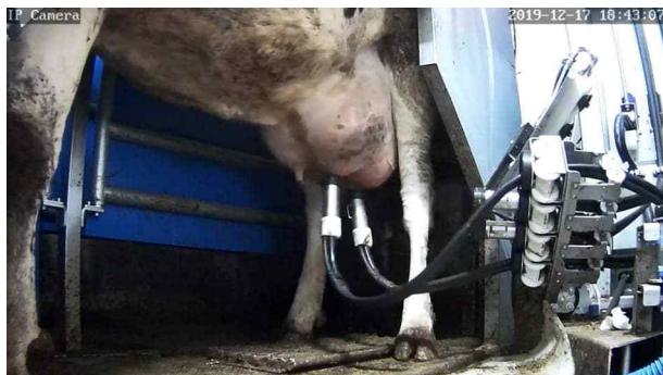
그림 249 가. 착유컵 자동 탈락 및 자동 복귀
