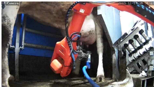
그림 243 가. 대기시간 경과 후, 로봇 ARM이 세척컵 그립 후 2차 이동, 세척컵 부착 2차 시도
