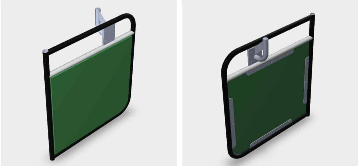
그림 70 착유스틀 게이트 3D 설계도(입구 도어)
