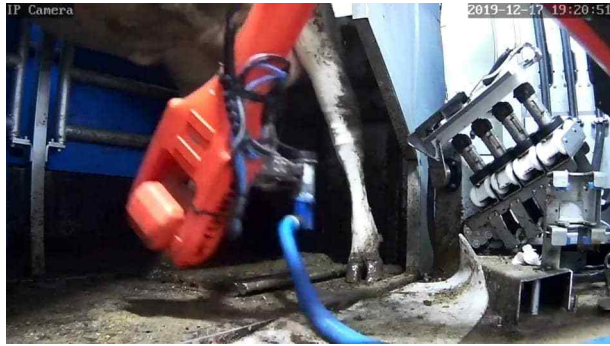
그림 253 나. 로봇 ARM이 세척컵을 그립(grip)하여 젓소 하단으로 이동, 유두 위치를 탐지 중
