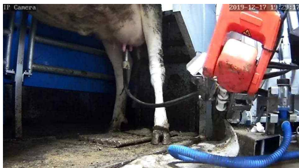
그림 267 나. 로봇 ARM이 착유컵 2차 그림
