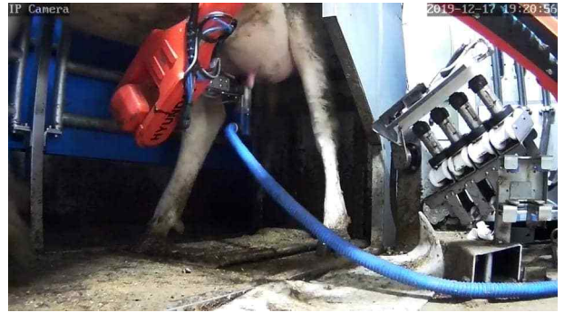
그림 254 나. 유두 위치를 탐지하여 세척컵을 부착하 려 할 때 젓소가 뒤쪽으로 이동, 세척 실패
