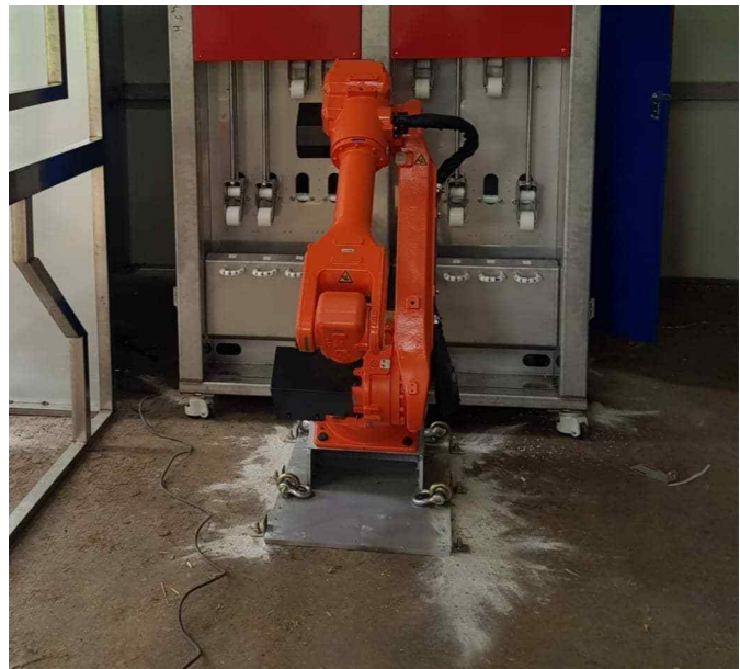
그림 189 로봇 매니플레이터 하부 고정
