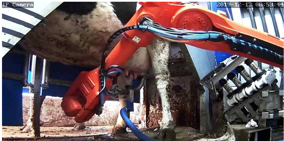
그림 213 세척과정③ 세척컵 탈착, 두 번째 유두(우측 뒤)로 세척컵 이동
