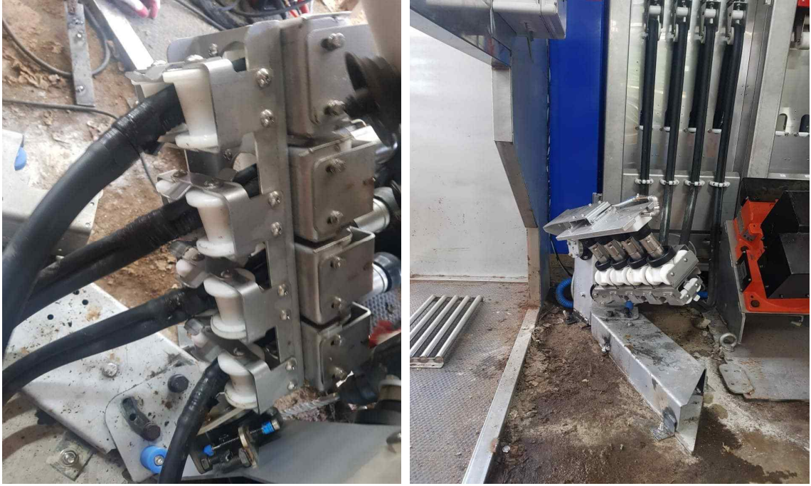
그림 192 착유 호스 연결 및 착유컵 대기 위치 설비
