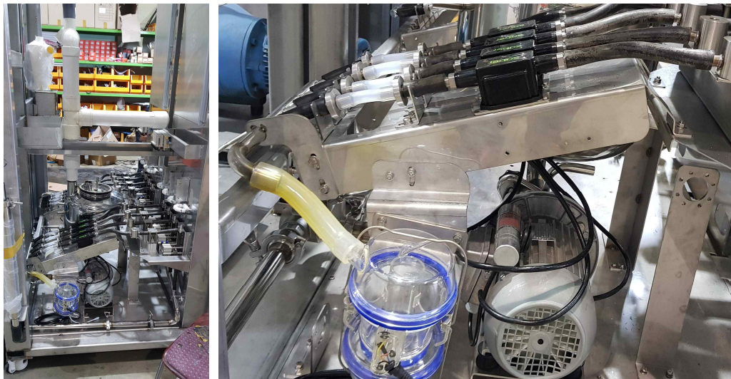
그림 179 분방 착유라인에 유질 및 유량검사장치 연결
