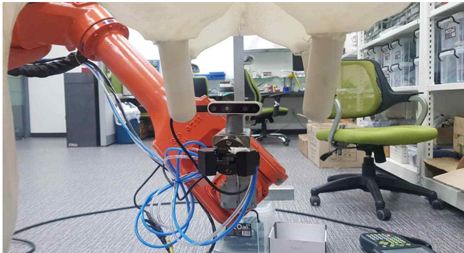
그림 79 Depth 카메라와 로봇 매니플레이터 결합 및 배선
