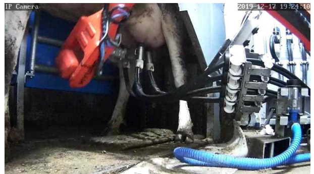
그림 264 나. 로봇 ARM이 착유컵 전체 부착 완료
