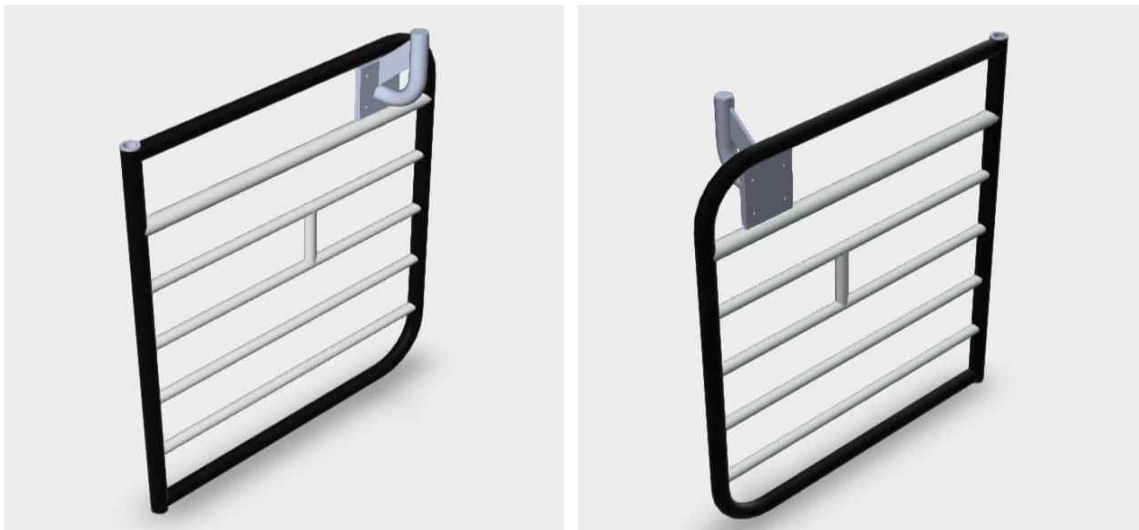
그림 71 착유스틀 게이트 3D 설계도(출구 도어)
