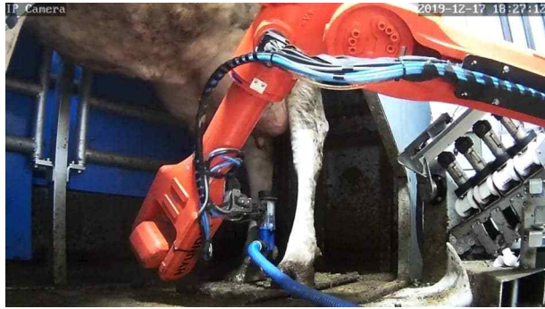
그림 239 가. 로봇 ARM이 세척컵을 그립(grip)하여 젖소 하단으로 이동, 유두 위치를 탐지 중
