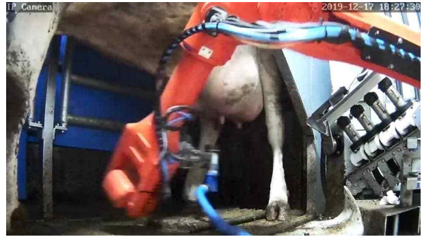
그림 240 가. 유두 위치를 탐지하여 세척컵을 부착하려 할 때 젖소가 뒤쪽으로 이동, 세척 실패
