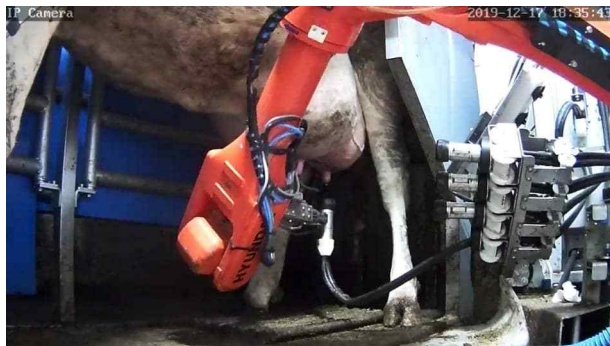
그림 245 가. 로봇 ARM이 착유컵 그립 후 이동
