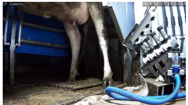
그림 276 나. 착유컵 자동 탈락 및 자동 복귀
