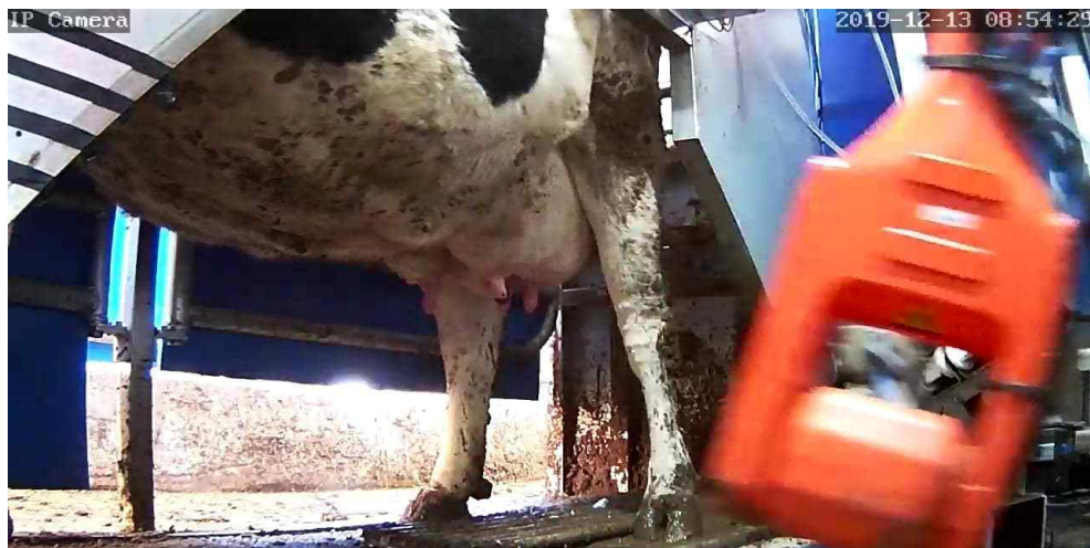
그림 219 세척과정⑨ 세척컵 최종 탈착 및 대기 위치로 복귀, 세척 종료
