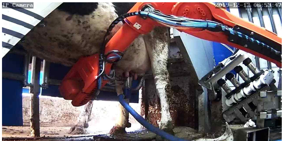
그림 214 세척과정④ 두 번째 유두(우측 뒤)의 위치 탐지, 세척컵 부착, 세척 수행
