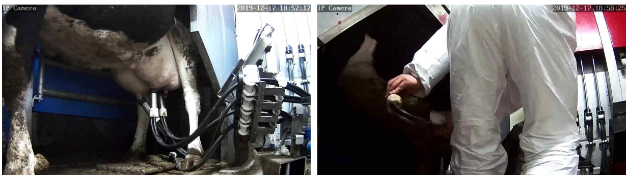
그림 278 착유 중 착유 호스를 우측으로 밟아 착유컵 탈락 및 착유 중단 사례, 작업자의 조치
