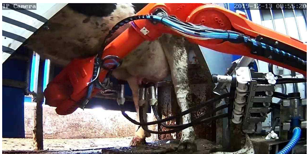
그림 227 착유과정⑦ 세 번째 유두(우측 앞)의 위치 탐지, 착유컵 부착, 착유 시작
