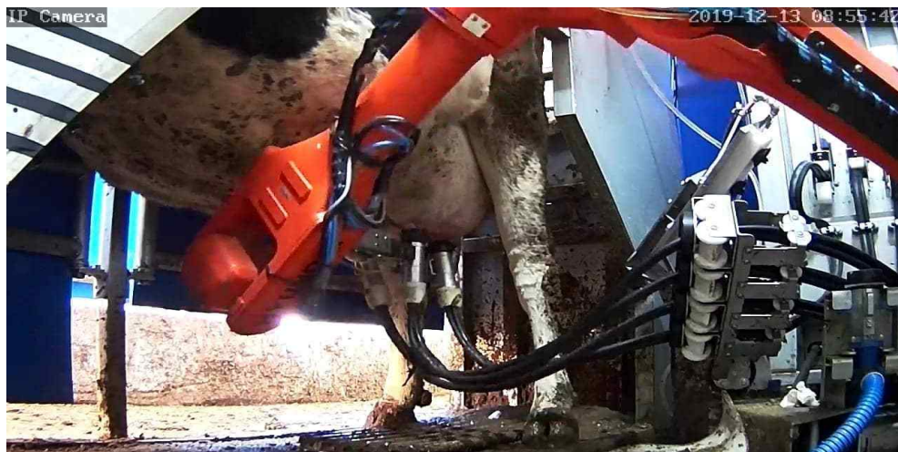
그림 229 착유과정⑨ 네 번째 유두(좌측 앞)의 위치 탐지, 착유컵 부착, 착유 시작
