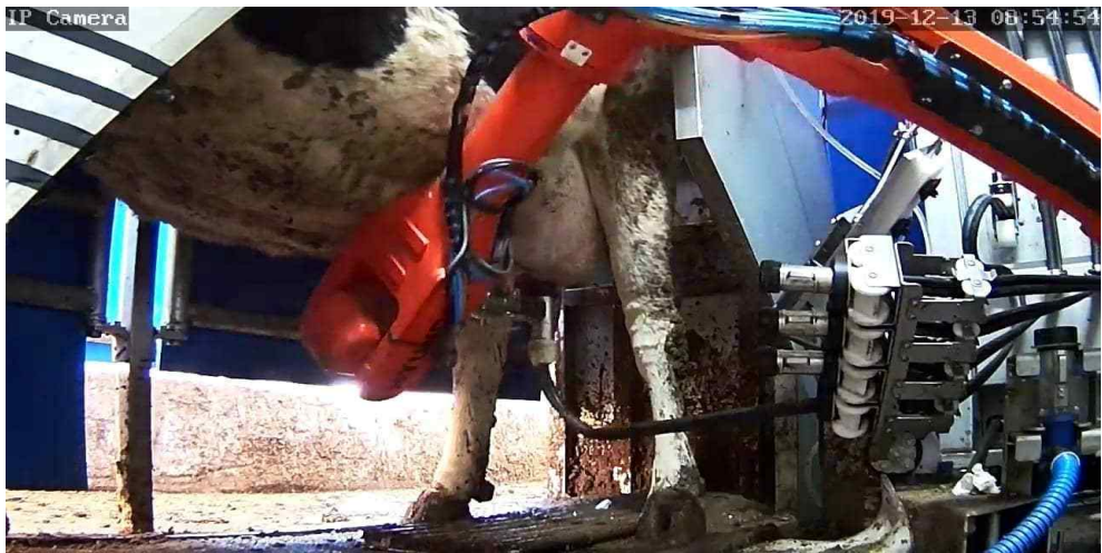
그림 223 착유과정③ 첫 번째 유두(좌측 뒤)의 위치 탐지, 착유컵 부착, 착유 시작
