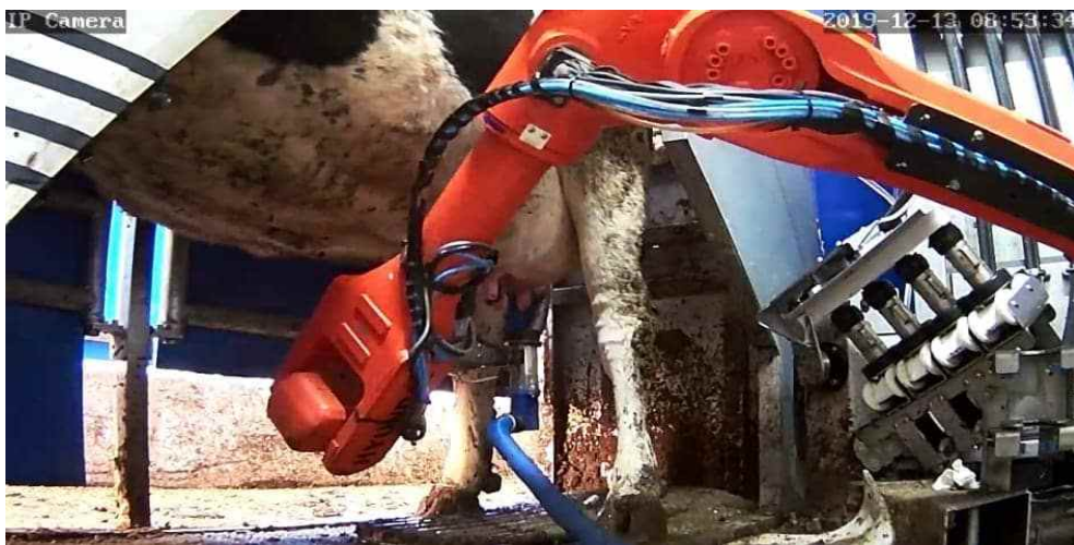
그림 211 세척과정① 로봇 ARM이 세척컵을 그림(grip), 젖소의 하단으로 세척컵 이동
