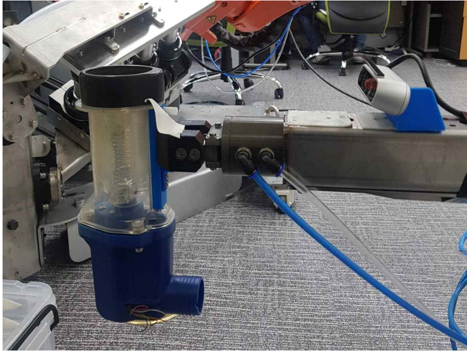
그림 83 Depth 카메라 적용한 로봇 ARM 및 그립퍼의 동작 검증(세척컵 그림)
