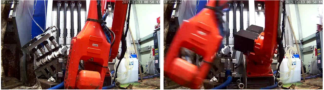
그림 236 로봇 ARM의 세척컵 그림(grip) 실패 사례
