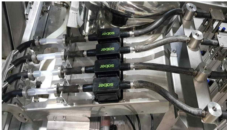
그림 144 4분방 착유라인별 유질분석기기 설치 사진(개선)
