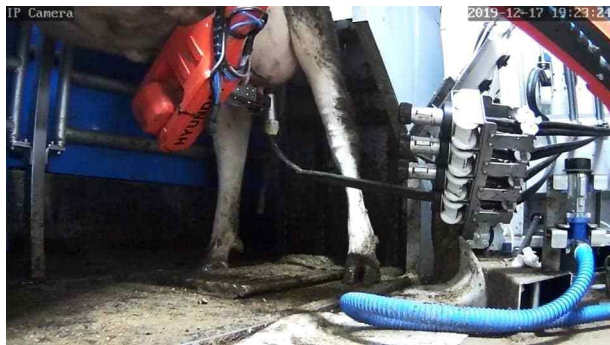
그림 263 나. 로봇 ARM이 착유컵 이동, 부착
