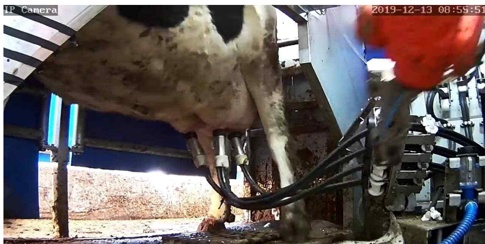
그림 230 착유과정⑩ 로봇 ARM 대기 위치로 복귀(착유 진행 중인 상태)
