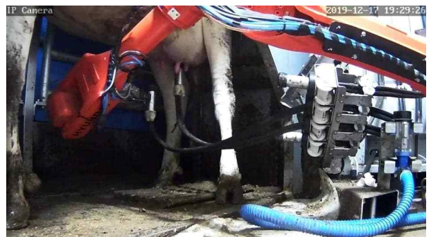
그림 268 나. 로봇 ARM이 착유컵 2차 이동 및 부착
