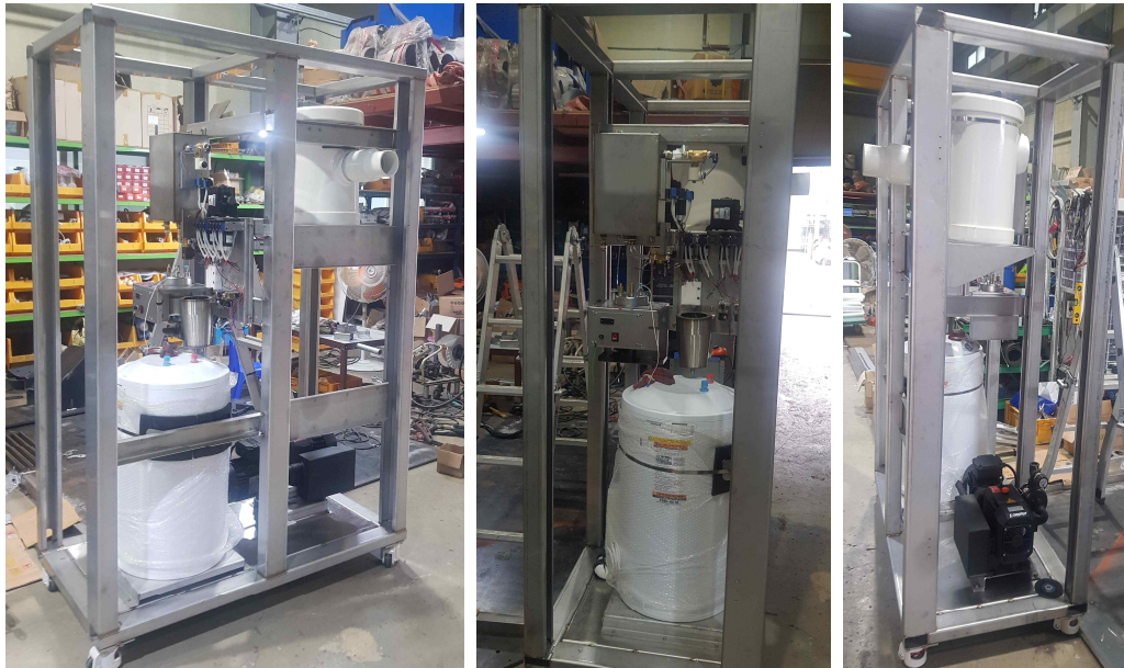
그림 182 세척라인용 탱크 조립
