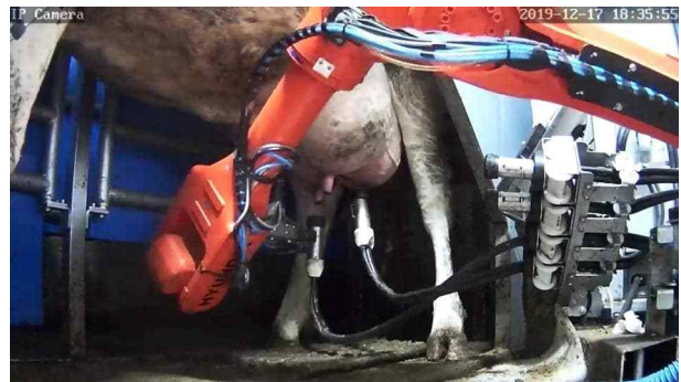
그림 246 가. 로봇 ARM이 착유컵 2개째 부착
