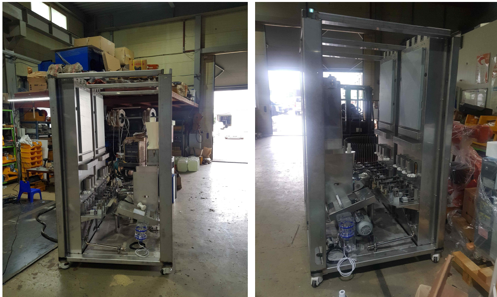
그림 177 분방 착유기에 유량분석장치 및 모터 연결
