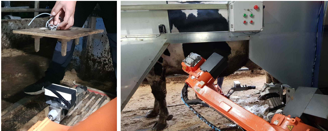
그림 205 유두 모형 및 실제 젖소의 입실을 통한 유두인식 기능 점검
