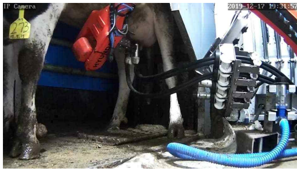
그림 271 나. 로봇 ARM이 착유컵 3차 이동 및 부착
