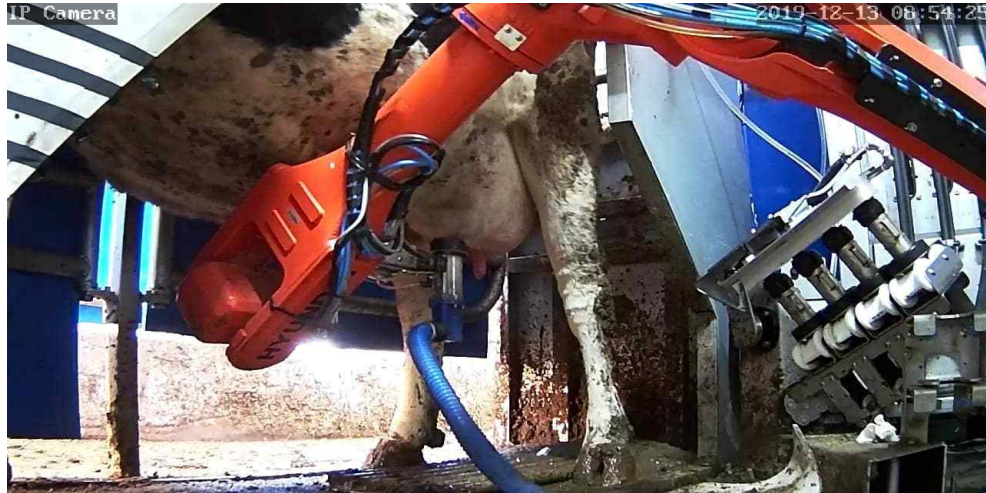
그림 218 세척과정⑧ 네 번째 유두(좌측 앞)의 위치 탐지, 세척컵 부착, 세척 수행
