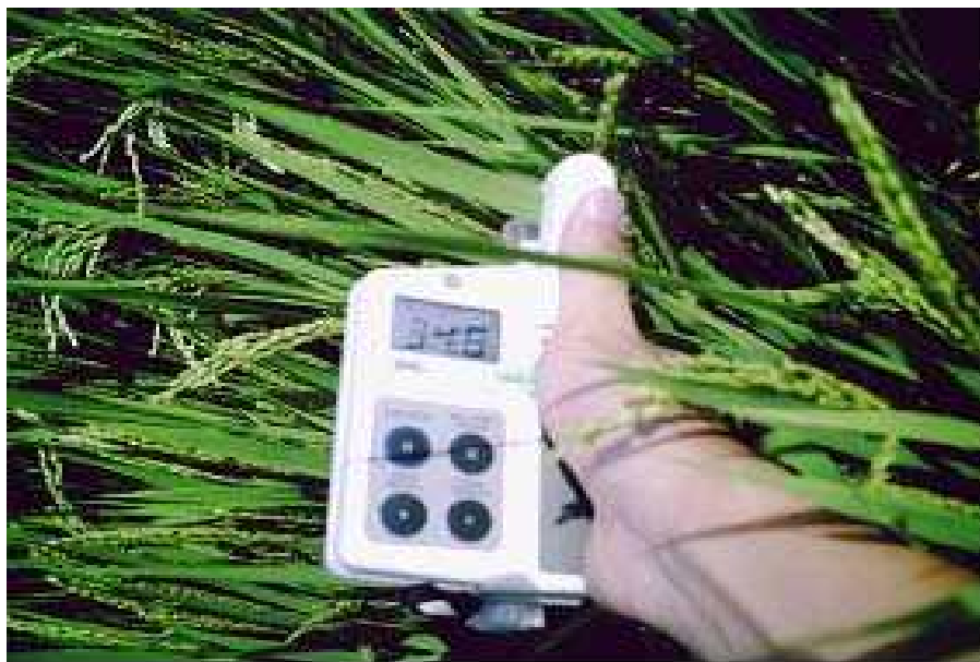
그림 52. 광합성 측정 (Model: SPAD-502, Konica Minolta).
