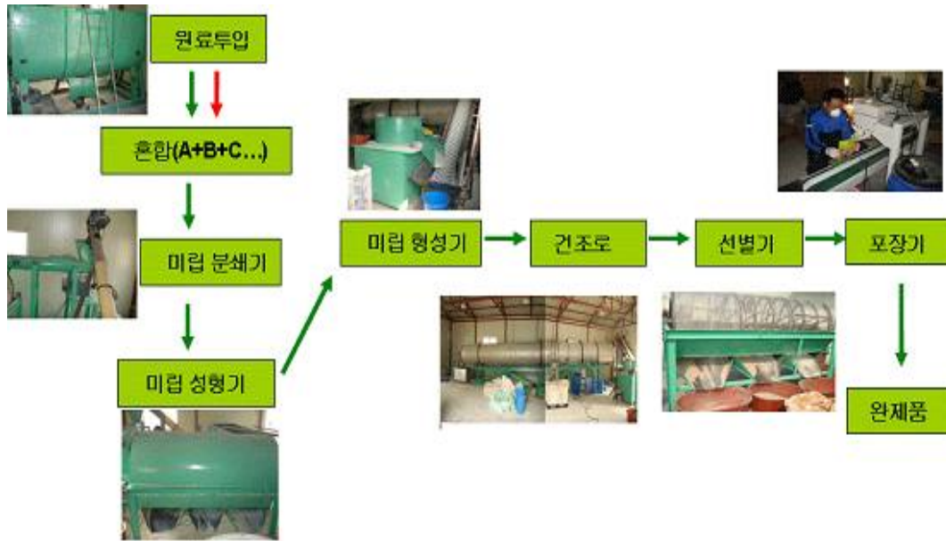
그림 26. 주박을 이용한 고체 친환경생물 소재의 제형화 단계.
