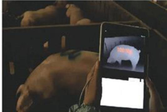
가. 본 개발기술은 3D스캐너를 이용하여 획득한 돼지의 영상정보 및 깊이 정보를 이용하여 돼지의 체중을 오차범위 5% 이내, 측정시간 10초이내로 측정이 가능하도록 개발
