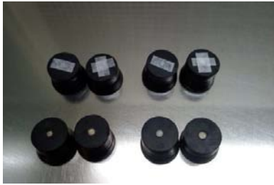
그림 3-6. 배양용기 고무 마개 사용시 슝 대신 micro pore 테이프 사용 위에서부터 시계 방향으로
