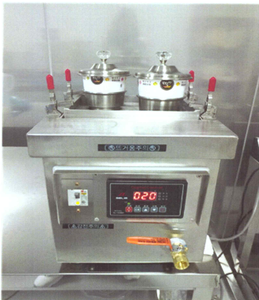
한국식품연구원(한식연) 금준석 박사 연구팀과 (주)라이스파이가 공동 개발한 즉석 떡 제조장치. 한식연 제공
