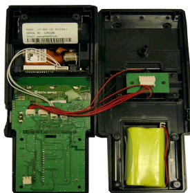
그림 1-6. 테스트용 부속도 측정기 Main-PCB 및 기구 조립.
