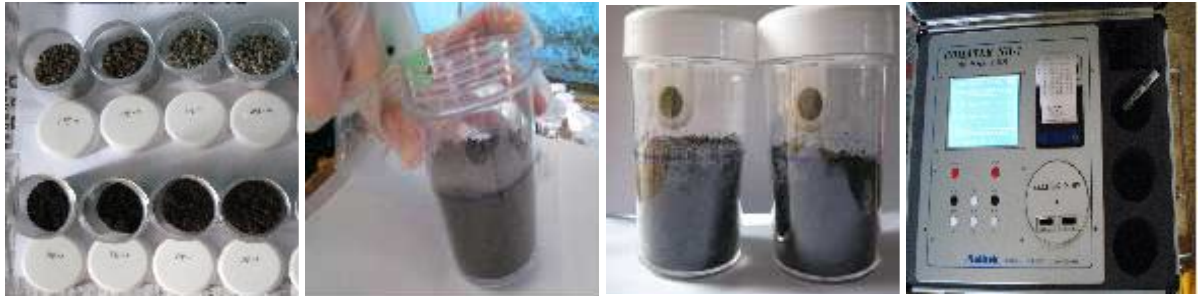
시료 채취 (200mL) 수분(15mL) 첨가 30분 상온 방치 부숙도 측정기 측정
