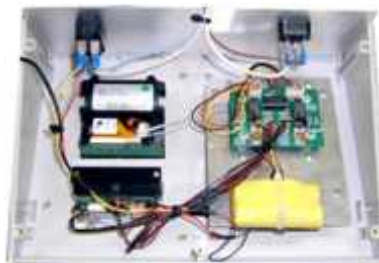
그림 1-19. 시제품용 부속도 측정기 내부 조립도.
