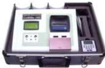
그림 1-23. 2차 개발된 시제품용 부숙도 측정기 세트.
