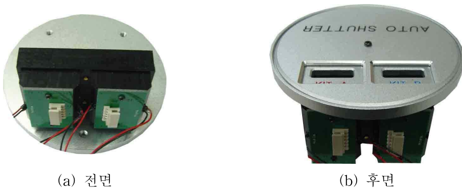
그림 2-26. 3차 상품용 부속도 측정기의 광학부 자동 덮개.
