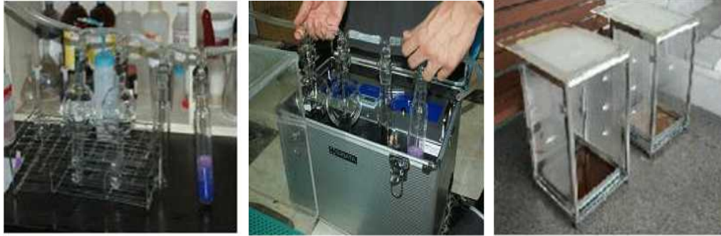
암모니아 가스 흡수용 임핀저의 구성
