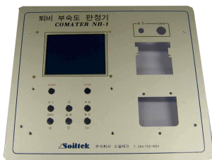
그림 1-42. 조립 2단계 : LCD 조립.
