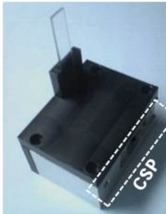
(g) 광학대 상부 덮개 결합(CSP : 센서 결합 위치)
