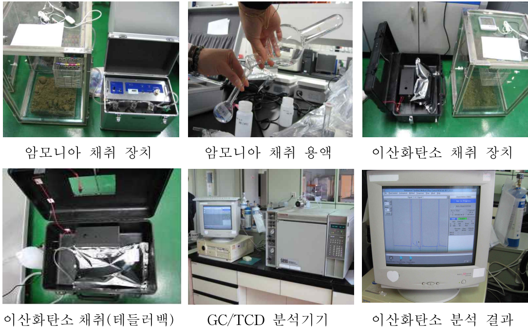
그림 3-12. 암모니아와 이산화탄소 채취 및 분석 (1차 실험)
