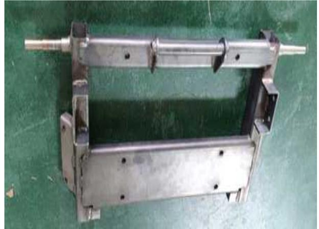
[그림] 궤도프레임 도면 및 제작 사진
