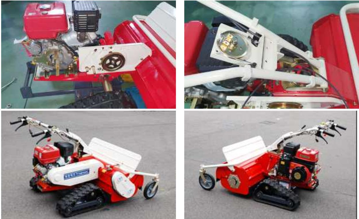
[그림] 궤도형 제초기 프레임, 작업부 최종조립 사진
