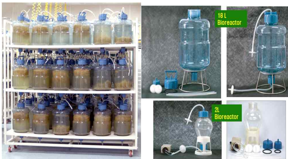
<그림> 개발 미생물의 대량 배양을 위한 Bioreactor system
