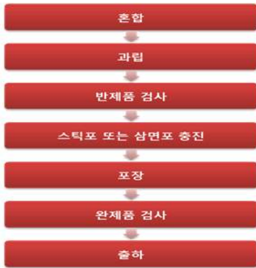
<그림> 발효진세노사이드 복합발효물 과립제품 제조공정도 및 레시피
