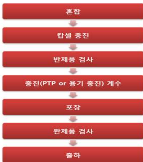
<그림> 발효진세노사이드 복합발효물 캡셀제품 제조공정도 및 레시피
