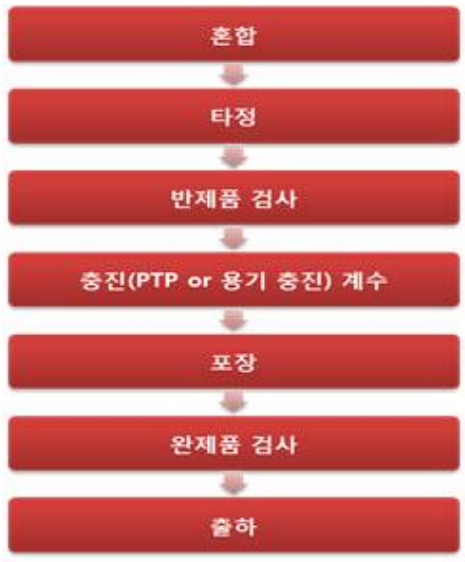
<그림> 발효진세노사이드 복합발효물 타정제품 제조공정도 및 레시피
