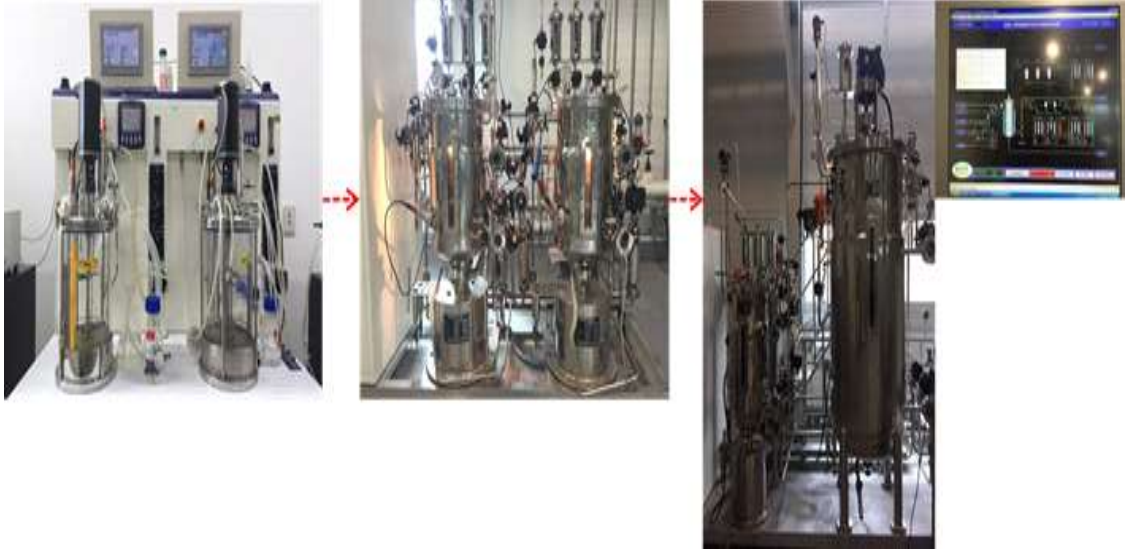
<그림> 발효진세노사이드 복합발효물 Scale-up 프로세스
