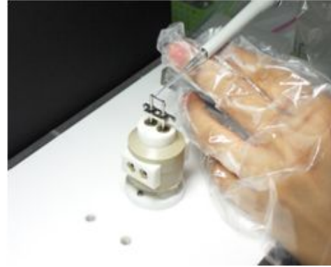
그림 3-2-13. 건조된 시료를 loader로 필라멘트에 얹는 작업
