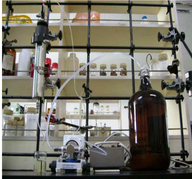
<Mulberroside A와 oxyresveratrol 분리정제에 사용한 MPLC 장치>
