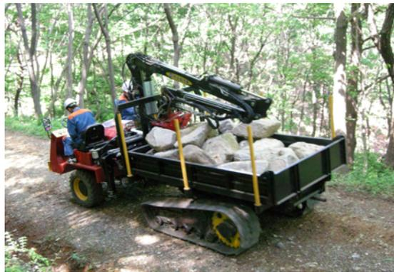
그림 3-71. 산림작업차 산림 토목자재 적재시 상·하향 주행성 테스트 모습.
