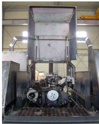
그림 3-48. 산림작업차량부의 엔진부 주요 부품과 구조물 및 제작 모습
