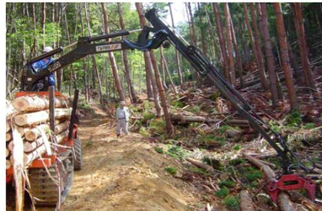
그림 6-10. 다양한 산림작업차용 로그그래플의 모습
