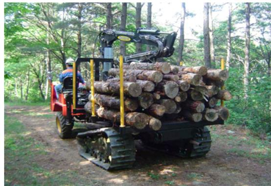
그림 3-70. 산림작업차 목재 적재시 상·하향 주행성 테스트 모습.
