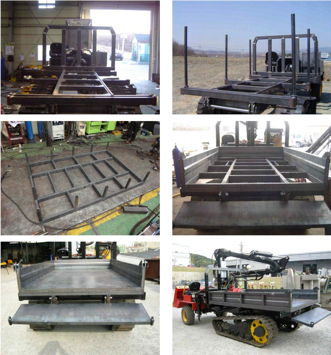
그림 3-56. 산림작업차량부의 적재부 구조물 및 제작 모습
