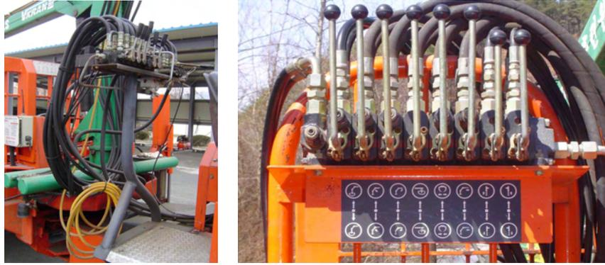
그림 6-12. 로그그래플의 조작대와 레버의 모습
