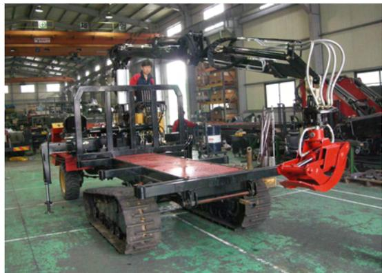
그림 3-66. 산림작업차량의 로그그래플 구조물 및 제작 모습
