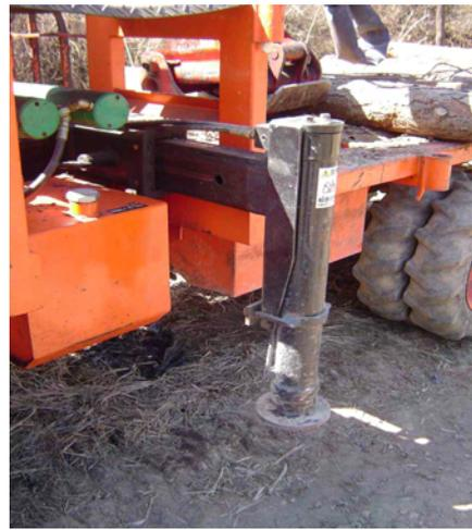
그림 3-19. 아우트리거(Out rigger)의 모습
