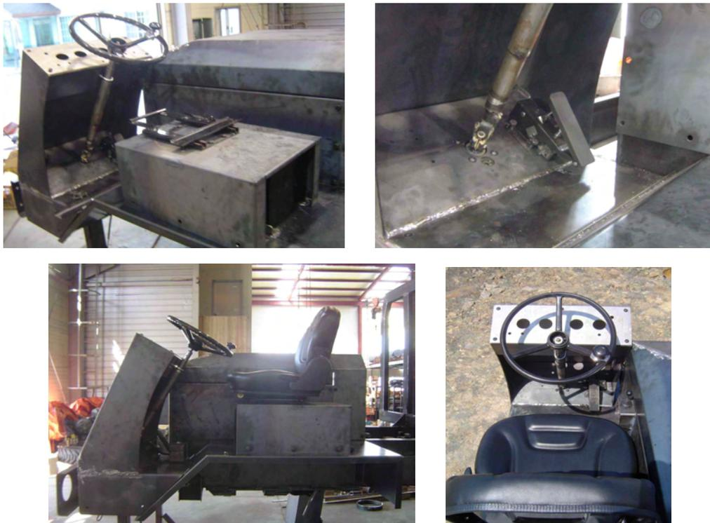
그림 3-54. 산림작업차량부의 조작부 주요 부품과 구조물 및 제작 모습
