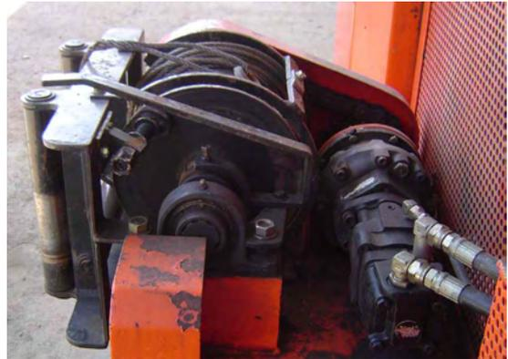
그림 6-8. 원목 견인용 윈치(Winch)의 모습
