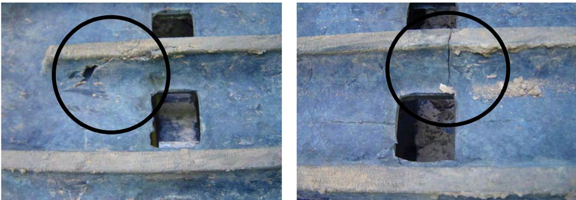
그림 3-73. 현장 적용성 테스트 후 후륜 고무크롤러 훼손 모습.
