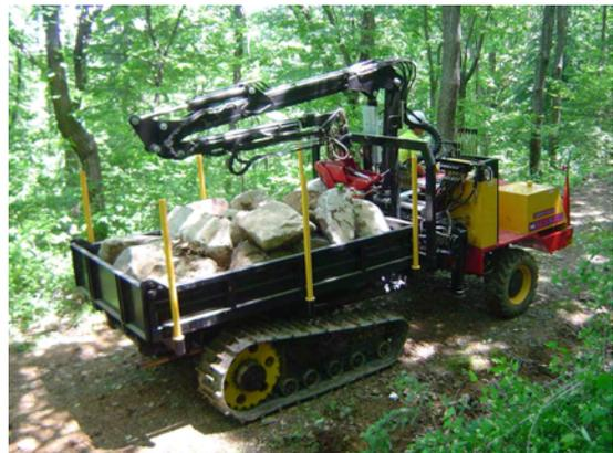
그림 3-67. 제작 완성된 반궤도식 다목적 산림작업차 시작기의 모습
