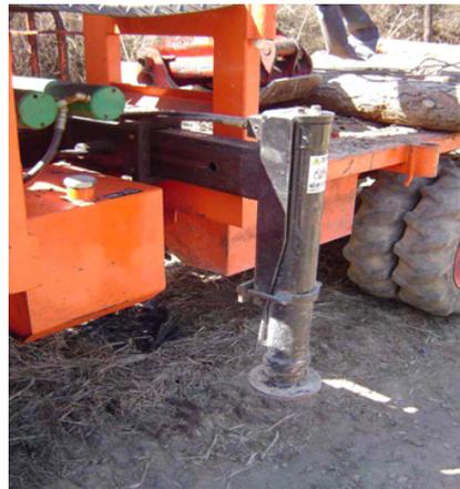
그림 6-9. 아우트리거(Out rigger)의 모습
