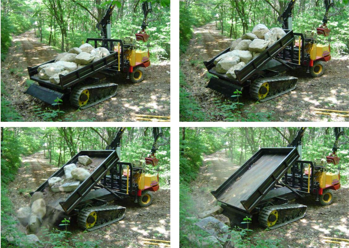
그림 3-72. 산림작업차의 덤프 테스트 모습.
