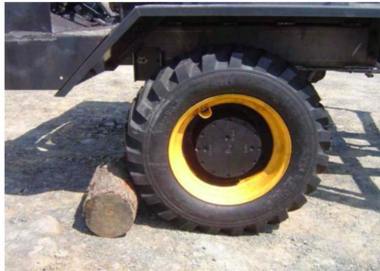
그림 3-50. 산림작업차량부의 전륜 고무바퀴부 주요 부품과 구조물 및 제작 모습
