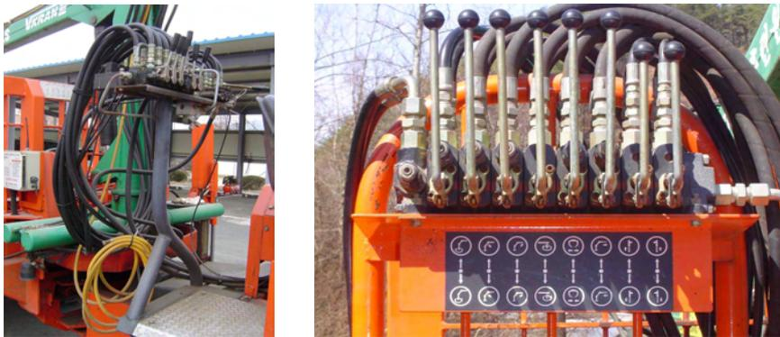
그림 3-22. 로그그레플의 조작대와 레버의 모습
