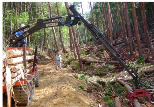
그림 3-20. 다양한 산림작업차용 로그그래플의 모습
