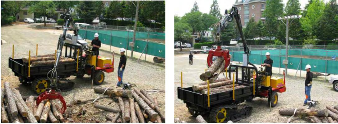
그림 3-76. 반궤도식 다목적 산림작업차 상하차 공정조사 모습
