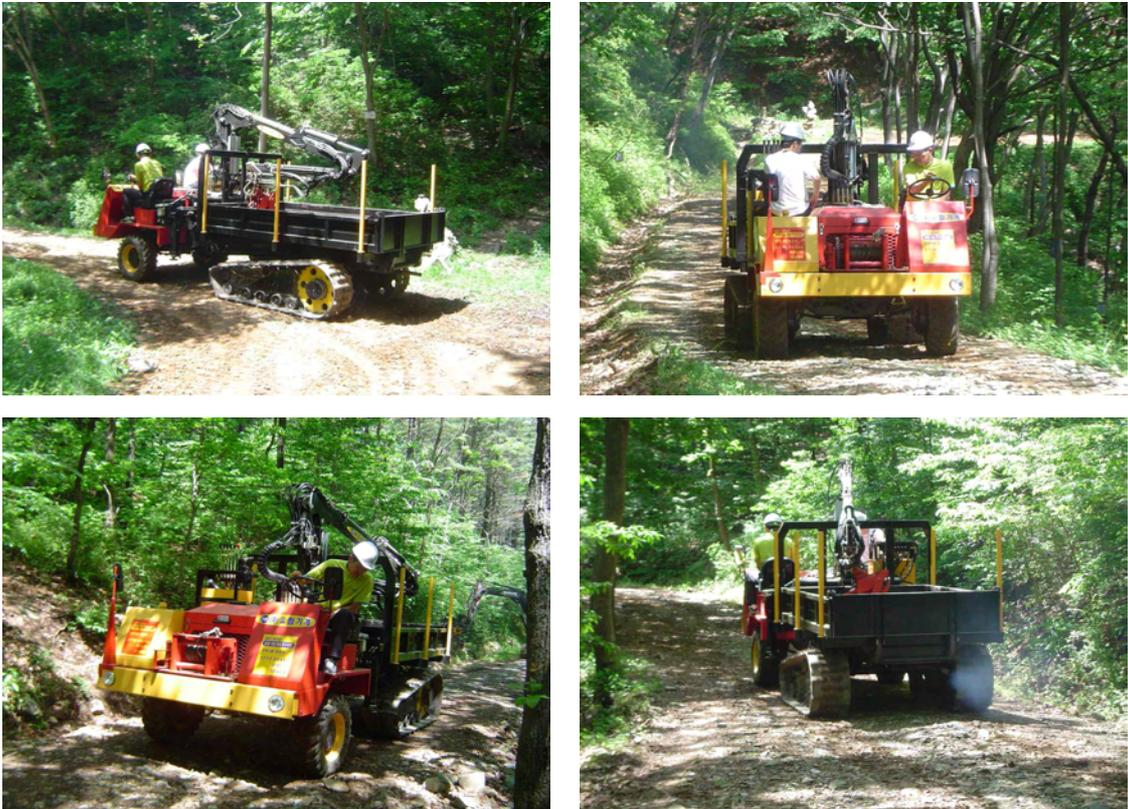
그림 3-69. 산림작업차 공차시 상·하향 주행성 테스트 모습
