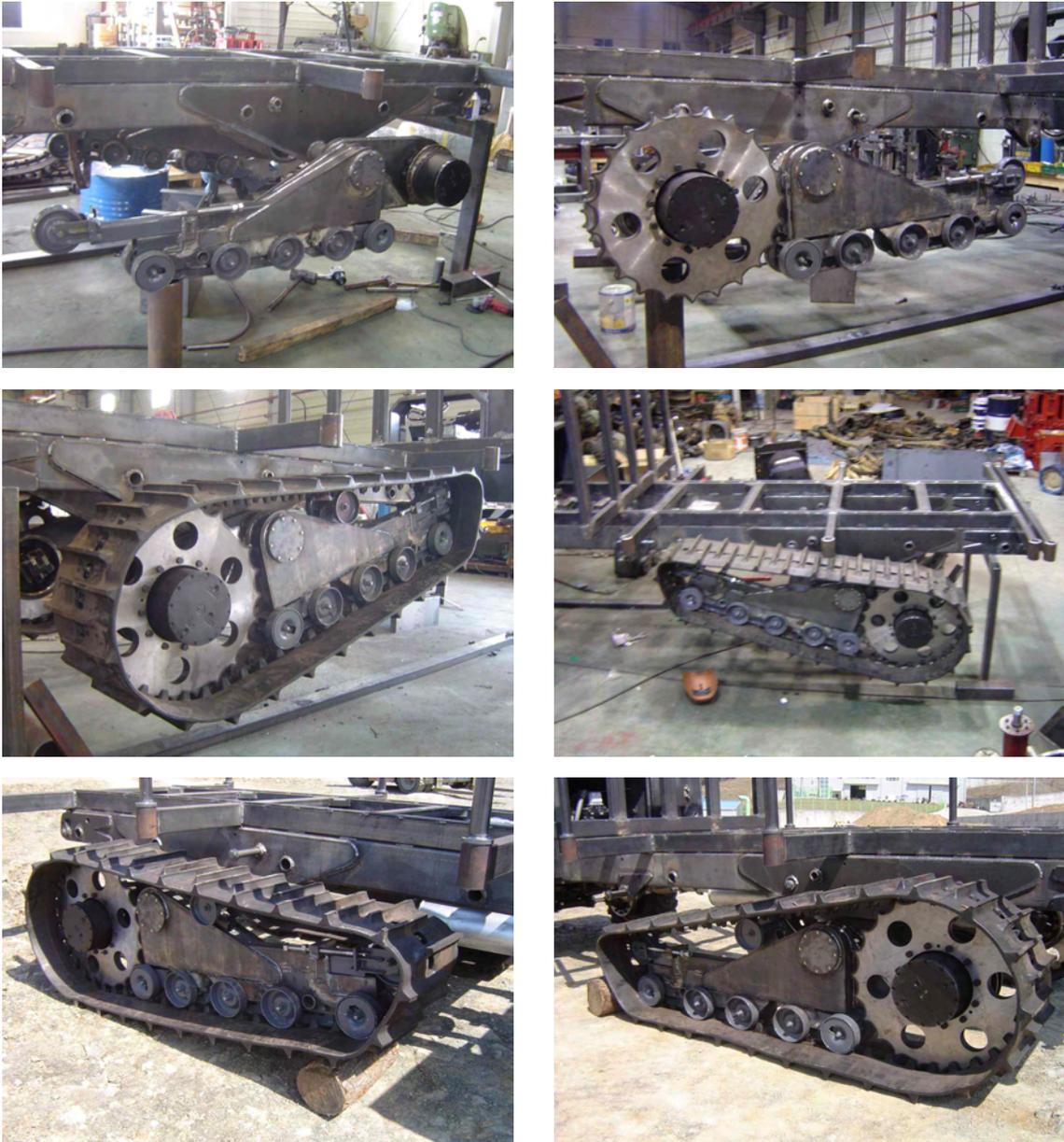
그림 3-52. 후륜 크롤러부 주요 부품과 구조물 및 시작기 제작 모습
