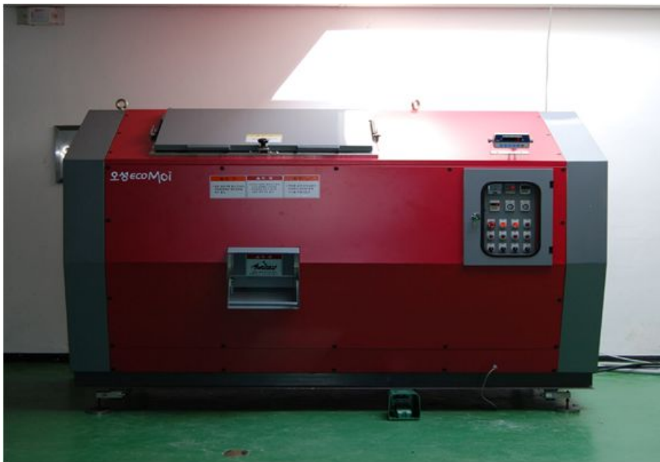
그림 31. 탈지강과 제오라이트를 이용한 HSB901균주 발효기
